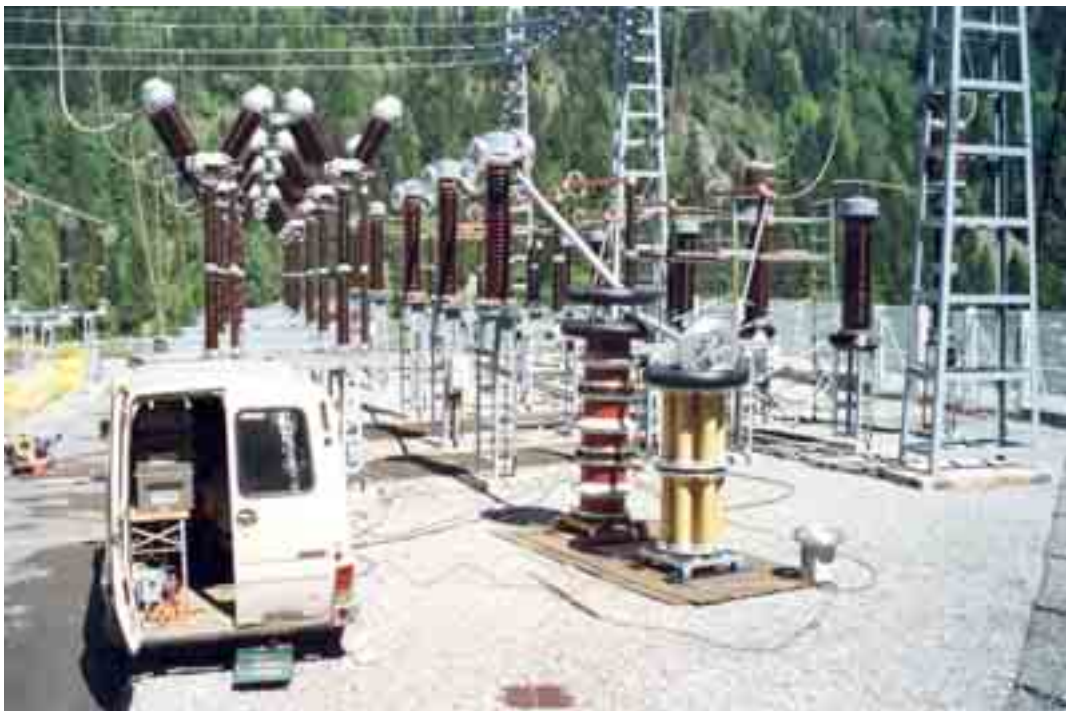
Abbildung 3 Photographie der Teilentladungsmesseinrichtung mit allen drei Messwandlergruppen in Brückenschaltung und Prüfspannungserzeugung mittels Serienresonanzkreis (Methode 2)
