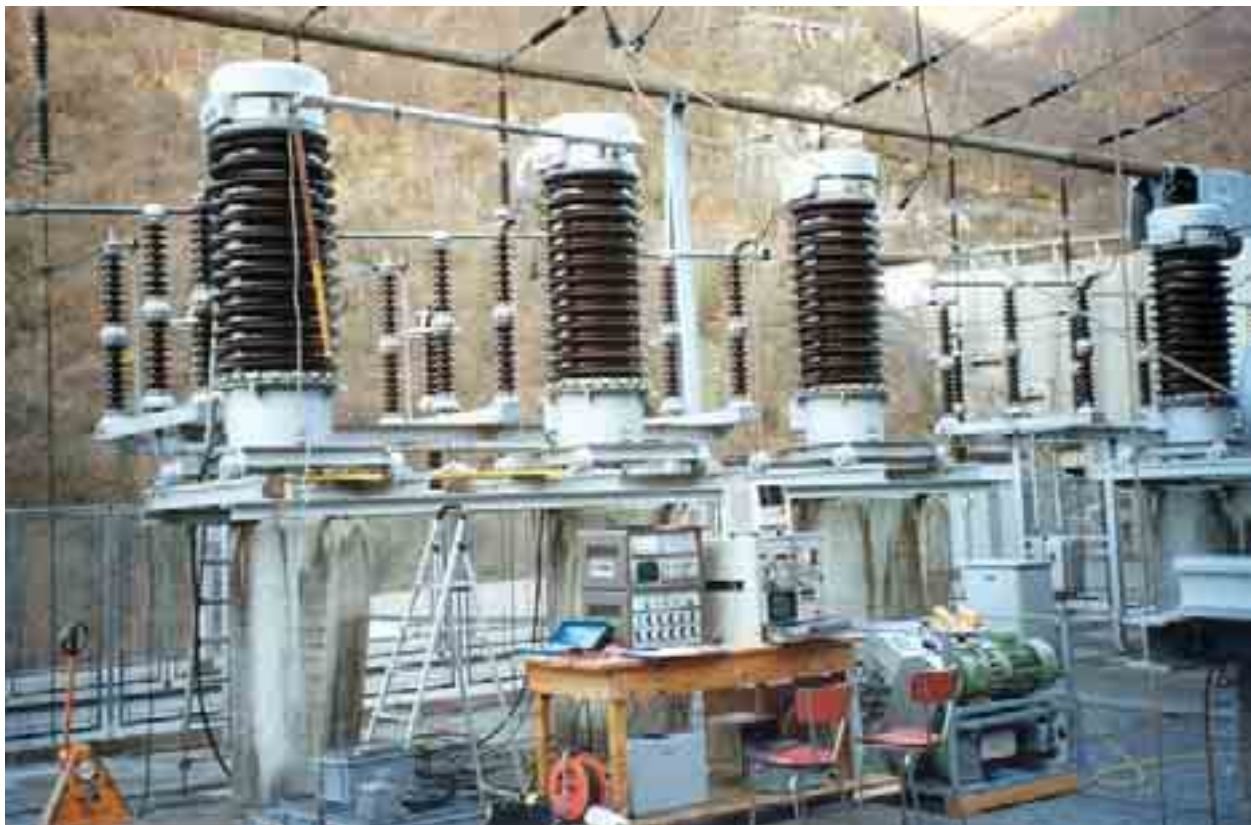
Abbildung 1 Vor-Ort-Teilentladungsprüfung zweier Messwandlergruppen, 150 kV, in Brückenschaltung nach Methode 1 (Verzasca AG, Zentrale Gordola). Im Vordergrund befindet sich die Prüfeinrichtung in offener Aufstellung, ohne Messwagen: Mitte: Teilentladungsmesseinrichtung bestehend aus Teilentladungsmessbrücke (Tettex) und phasenauflösendes TE-Messsystem rechts: Frequenzumformergruppe
