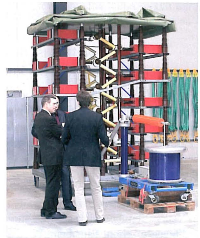
Mehrstufiger Marx-Generator der FKH für Stossspannungsprüfungen.
