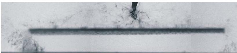
*Bild 3: Aufnahme eines electrical tree beim Wachstum um eine Barriere.*
