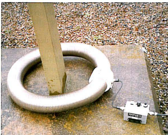
Bild 11: Messung des Erdseilstromes am Mastfuss mit grosser Rogowski-Spule.
