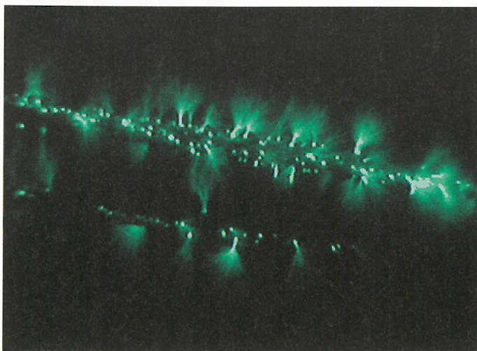
Bild 2 UV-Videobild bei nassem Doppelleiterbündel (Aufnahme: ETH, Fachgruppe Hochspannungstechnologie).
