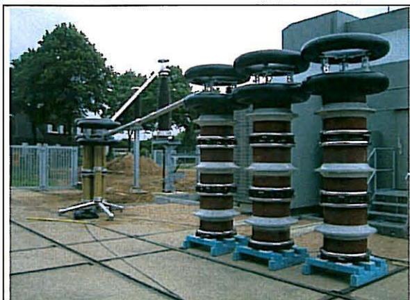
**Bild 7** Koppelkondensator, Spannungsteiler, Freiluftendverschluss, Resonanzdrosseln
