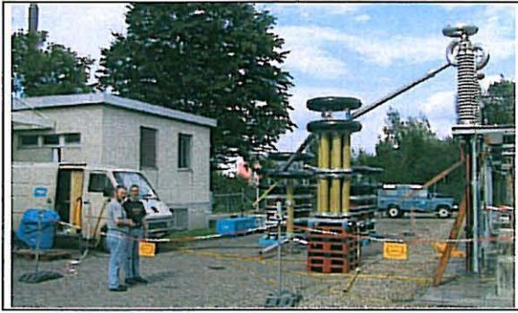
**Bild 13** Prüfanlage mit Koppelkondensator, Freiluftendverschluss
