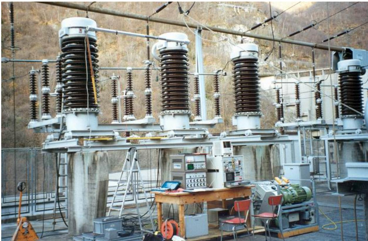
**Abbildung 1**    **Vor-Ort-Teilentladungsprüfung zweier Messwandlergruppen, 150 kV, in Brückenschaltung nach Methode 1 (Verzasca AG, Zentrale Gordola).**
