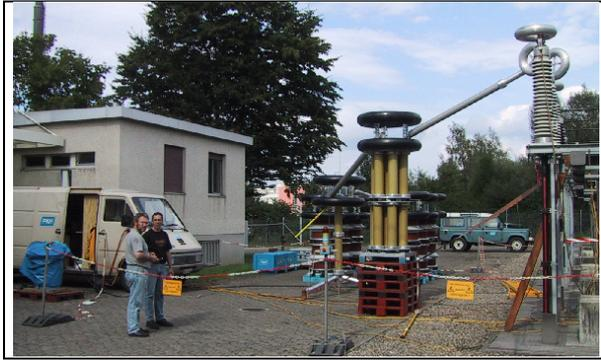
**Bild 13** Prüfanlage mit Koppelkondensator, Freiluftendverschluss
