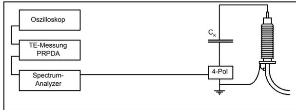
**Bild 2** Prinzip der elektrischen TE-Messung mit Koppelkondensator
