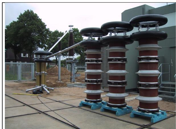
**Bild 7** Koppelkondensator, Spannungsteiler, Freiluftendverschluss, Resonanzdrosseln
