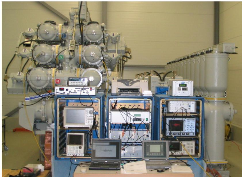
**Abbildung 3:** Ansicht des UHF-TE-Messsystems
