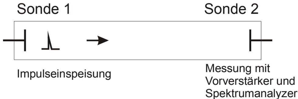
**Abbildung 6:** Empfindlichkeitsnachweis, Einspeisung eines equivalenten "5pC Pulses" an Sonde No. 1 und Messung an Sonde No.2. Die beiden UHF Messsonden sind auf einer Sammelschiene platziert, Distanz ca. 15m.
