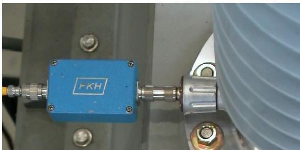
**Abbildung 30** Koaxialer Anschluss eines HF-Wandlers (TE-Sensor) an den Messbelag der Durchführung
