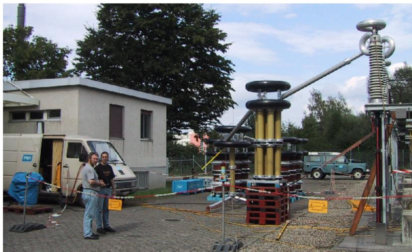
Abbildung 12: Prüfanlage mit Koppelkondensator, Freiluftendverschluss
