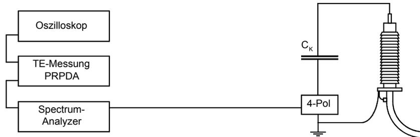
Abbildung 11: Prinzip der elektrischen TE-Messung mit Koppelkondensator
