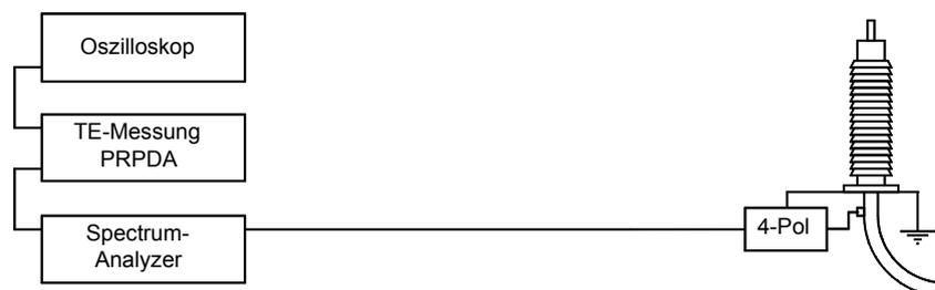
Abbildung 13: Prinzip der TE-Auskopplung am Kabelschirm
