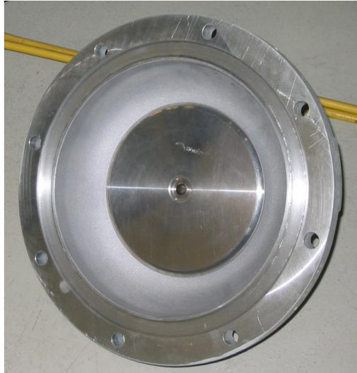
**Abbildung 2:** In einen Gehäusedeckel integrierte Feldsonde (TE-Sensor)
