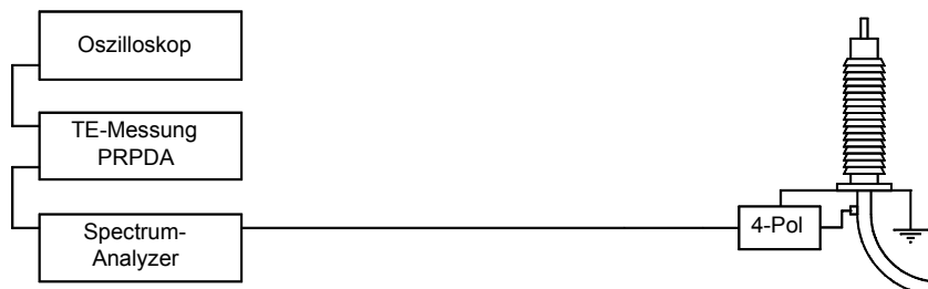
Abbildung 13: Prinzip der TE-Auskopplung am Kabelschirm
