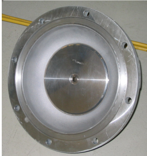
Abbildung 2: In einen Gehäusedeckel integrierte Feldsonde (TE-Sensor)
