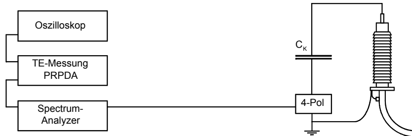
Abbildung 11: Prinzip der elektrischen TE-Messung mit Koppelkondensator
