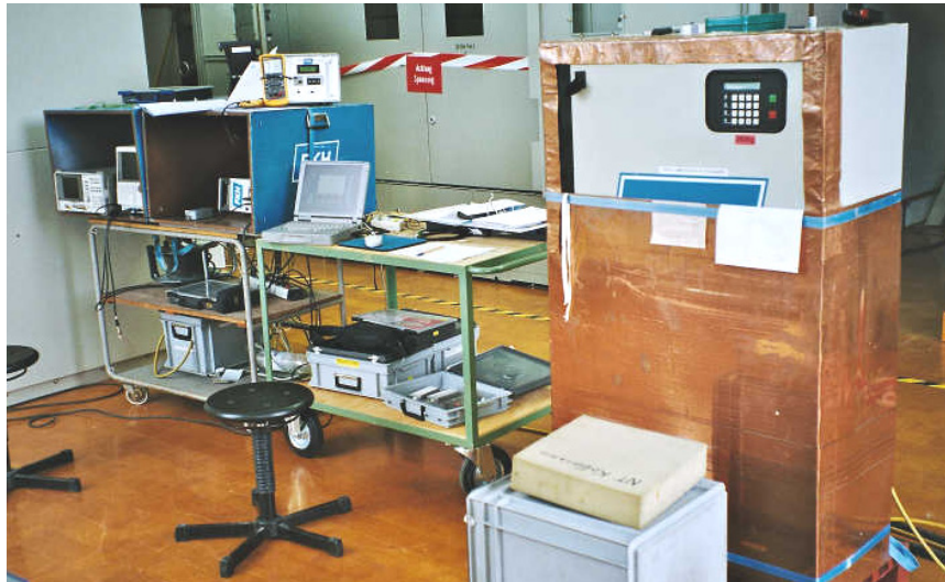
Abbildung 19 TE-Prüfeinrichtung: Links TE-Messeinrichtung, rechts Frequenzumrichter zur Einspeisung in die Sekundärwicklung des Spannungswandlers
