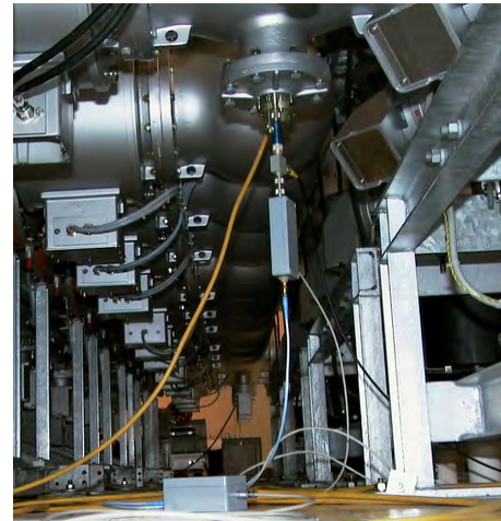
Abbildung 6 a) Prüfung einer um ein Schaltfeld erweiterten 132-kV-GIS aus dem Jahre 1988 b) Messung an einem Teilentladungssensor des im Jahre 2001 angebauten Felds
