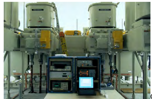
Abbildung 10 a) TE-Ankopplung an den Steck-Kabelendverschlüssen der GIS (Messstelle 2) b) TE-Ankopplung am Transformatorsternpunkt (Messstelle 4) c) Teilentladungsmesssystem
