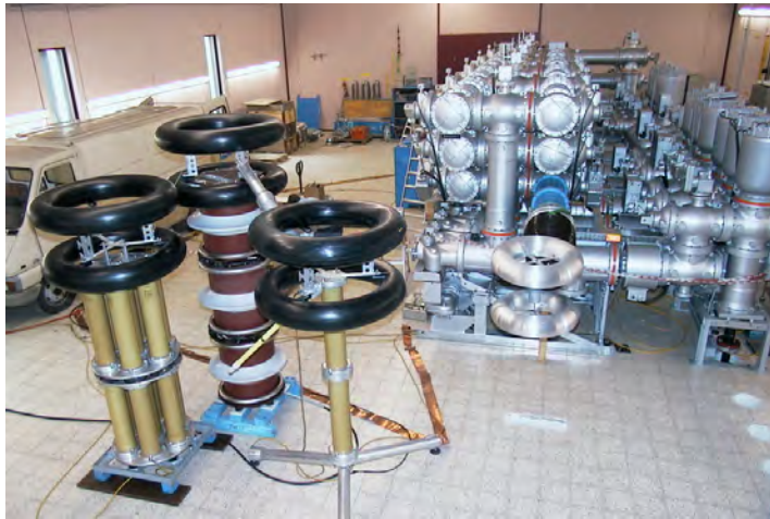
Abbildung 6 a) Prüfung einer um ein Schaltfeld erweiterten 132-kV-GIS aus dem Jahre 1988 b) Messung an einem Teilentladungssensor des im Jahre 2001 angebauten Felds
