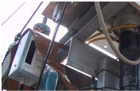
Abbildung 9 a) TE-Ankoppelvierpol am Kabelendverschluss der Kabelausleitung (Messstelle 1) b) Prinzipschema des Teilentladungsmesssystem am HS-Kabel
