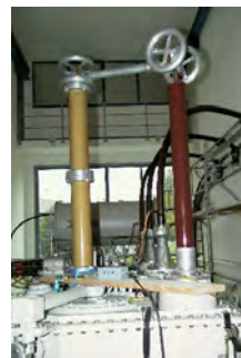
Abbildung 10 a) TE-Ankopplung an den Steck-Kabelendverschlüssen der GIS (Messstelle 2) b) TE-Ankopplung am Transformatorsternpunkt (Messstelle 4) c) Teilentladungsmesssystem
