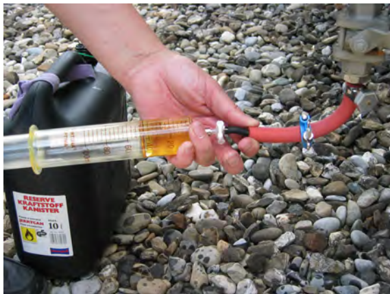
Abbildung 11 a) Probenahme für die Zersetzungsgasanalyse im Isolieröl b) Gasextraktion und Gaschromatographen für die Zersetzungsgasanalyse
