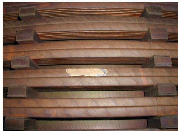
Fig. 2. Schlammablagerungen am Wicklungspapier
