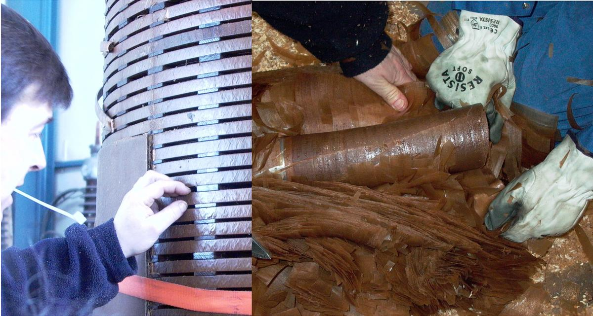
**Abbildung 5** Entnahme von Papierproben nach über 40 Jahren Betrieb (Fa. Weidmann, FKH), 600/3-MVA-Autotransformator 380/220 kV während dem Rückbau durch NOK
