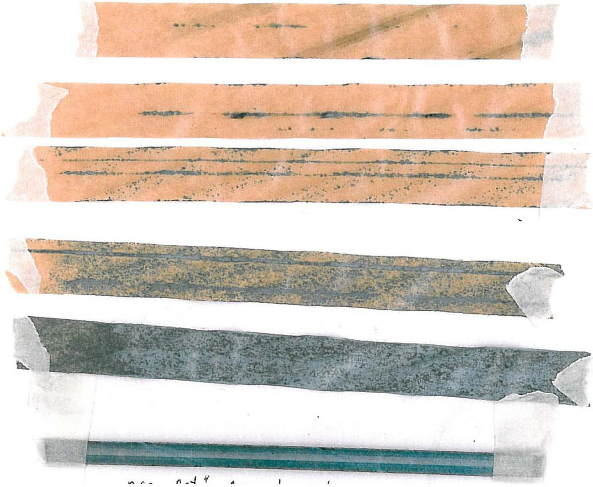
**Abbildung 6:** Leiter und die 5 Papierlagen der Reihe nach eines havarierten Transformators aus Norwegen. Havarieursache: korrosiver Schwefel im Öl
