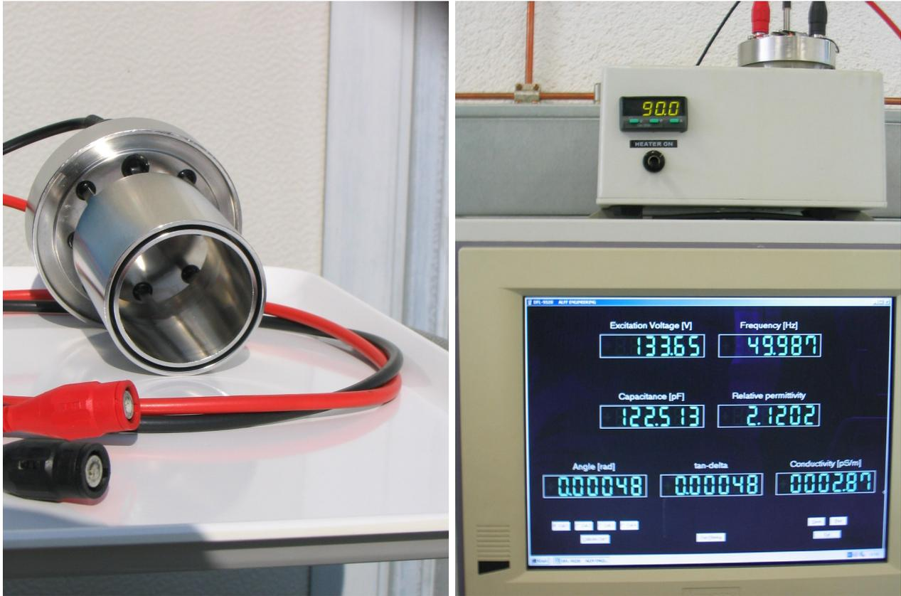
**Abb. 4. tg $\delta$ -Messzelle und Messanordnung**
