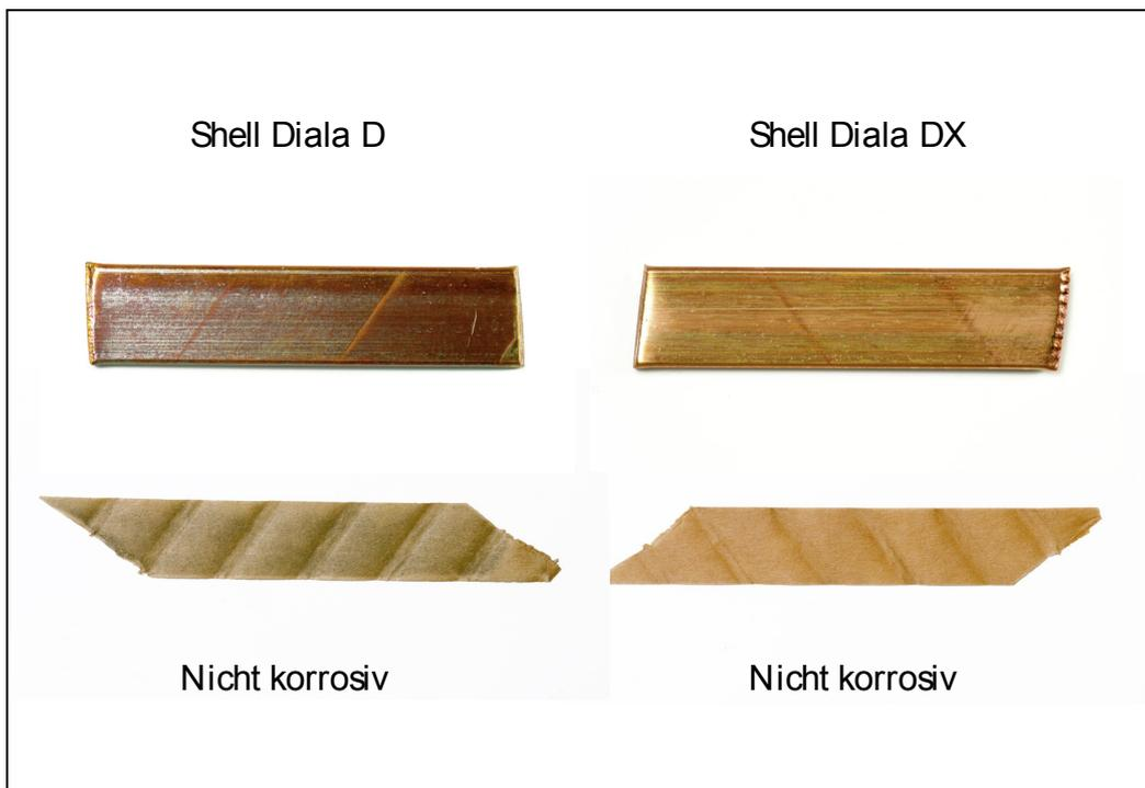
Figur 4: IEC 62535 Ergebnisse der reformulierten Shell Diala D und Shell Diala DX
