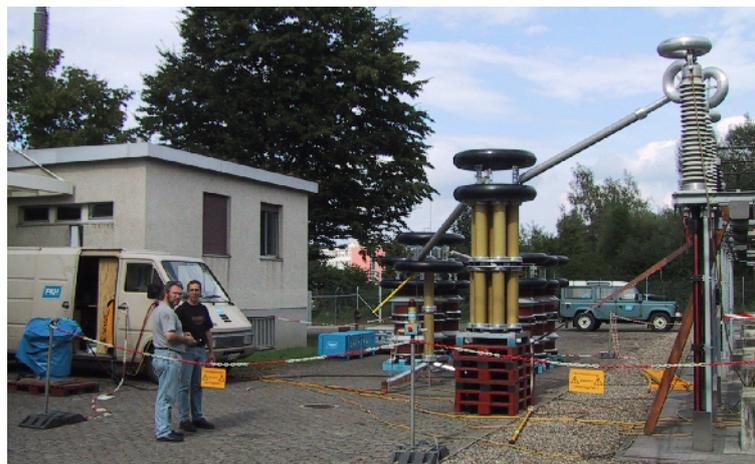
Abbildung 7: Prüfanlage mit Koppelkondensator, Freiluftendverschluss
