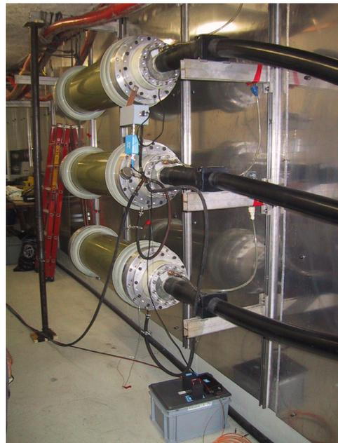
Abbildung 12: TE-Messung an der Sperrmuffe
