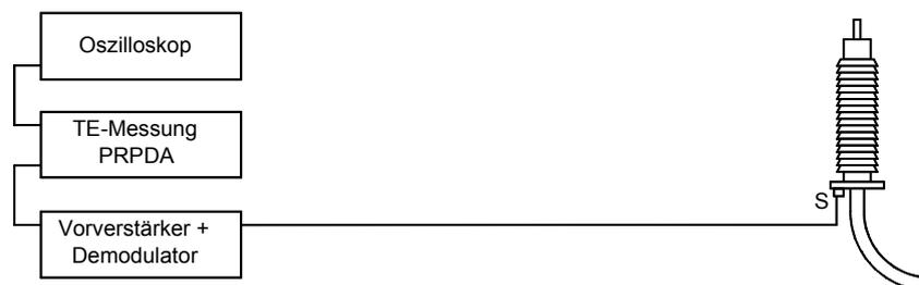
Abbildung 6: Prinzip der akustischen TE-Messung
