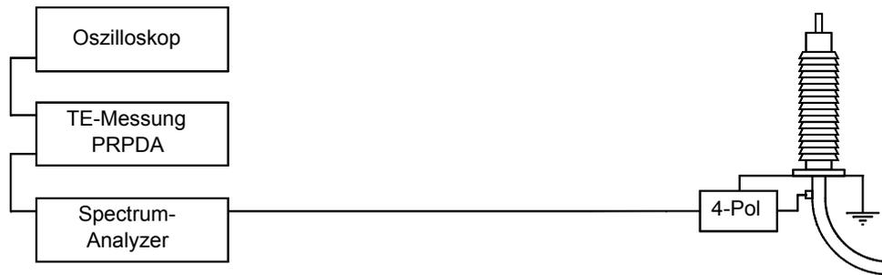
**Abbildung 3: Prinzip der TE-Auskopplung am Kabelschirm**
