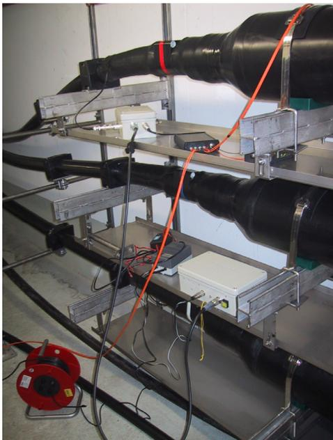
Abbildung 11: TE-Messung an den Muffen
