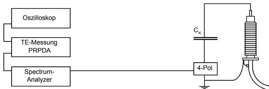
Abbildung 2: Prinzip der elektrischen TE-Messung mit Koppelkondensator
