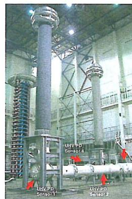
**Bild 6** Type Test eines 1100-kV-Trenners
