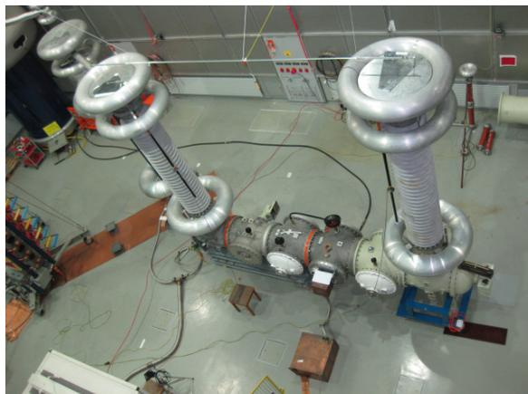
**Abbildung 3: Versuchsaufbau zur Evaluation von Durchschlagswahrscheinlichkeiten in Hochspannungsschaltkontakten**
