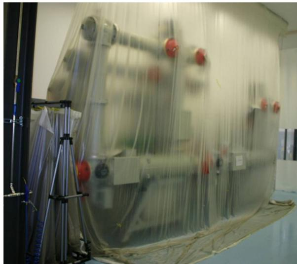
Integrale Prüfung der kompletten GIS Felder
