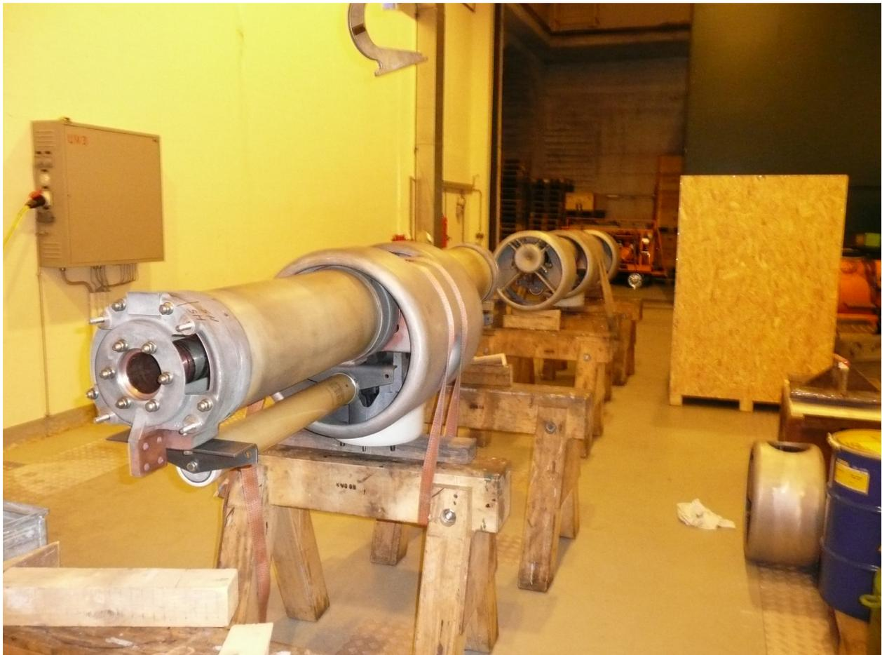
**Bild 5** Ausgebaute Aktivteile der Leistungsschalter. Links unter der Schaltkammer ist einer der beiden Steuerkondensatoren sichtbar.
