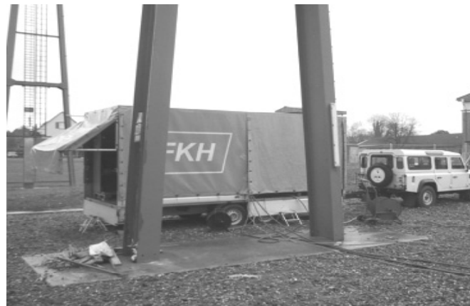
Abbildung 13 Stromquelle für die Einspeisung eines künstlichen Erdschlussstroms im Unterwerk
