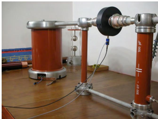
Figure 4: Installation de laboratoire avec transformateur monophasé de haute tension.
