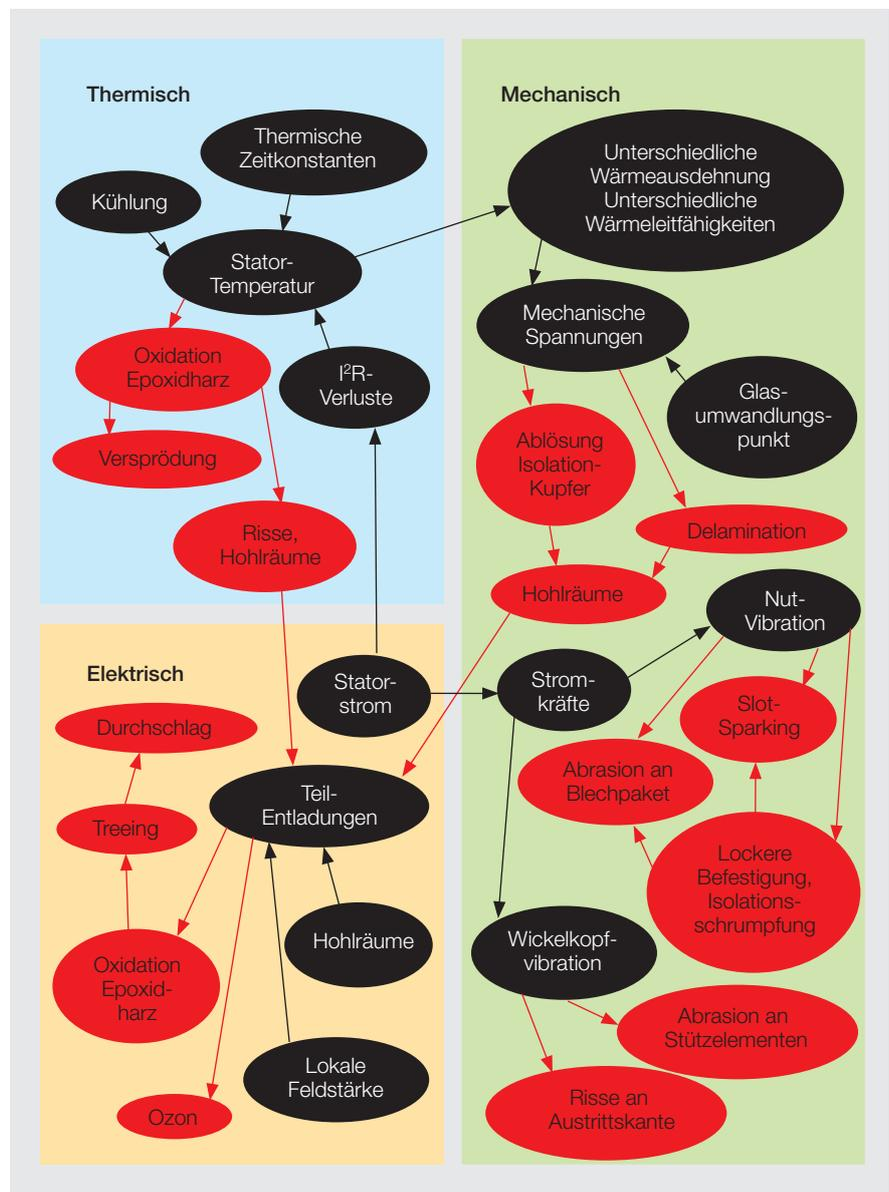
**Bild 1** Thermische, elektrische und mechanische Alterungs- und Schadensmechanismen. Schwarz markiert sind betriebs- und konstruktionsbedingte Einflussgrößen. Rot markiert sind Alterungs- und Schadensmechanismen. Die Pfeile verdeutlichen die Interaktionen.
