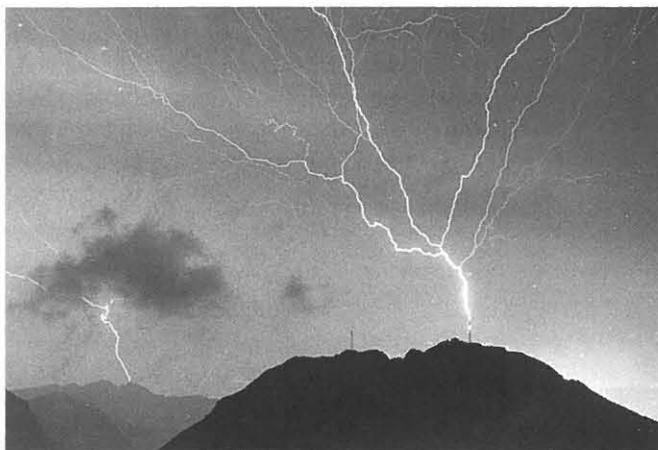
**Bild 4:** Aufwärtsblitz-Einschlag in Messturm.
