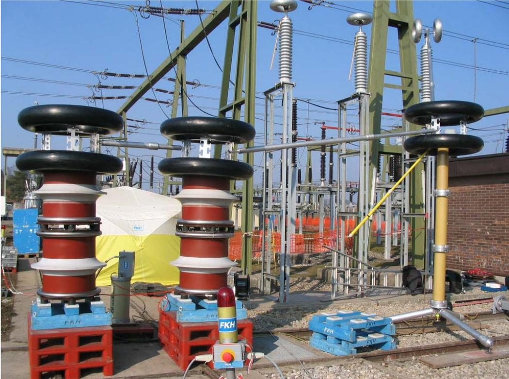
Abbildung 5 Serie-Resonanzanlage bei der Prüfung einer 123-kV-GIS (Einspeisung der Prüfspannung über das Trafokabel)
