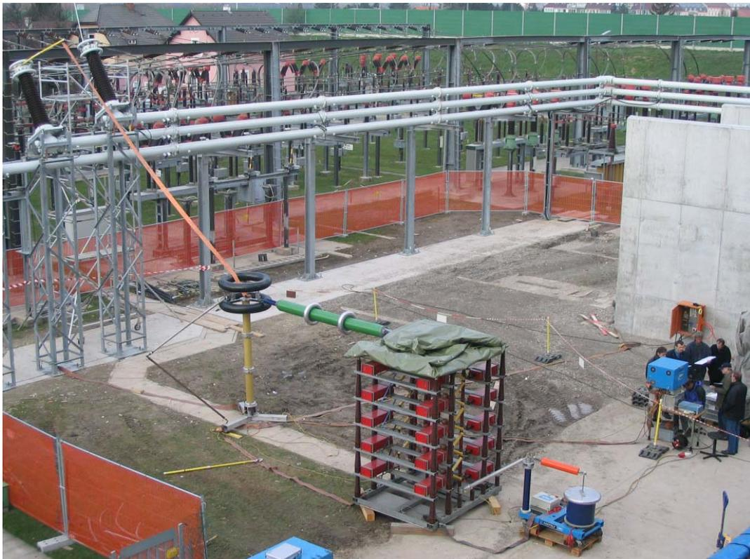
Abbildung 4 FKH-Stossgenerator bei der Prüfung einer 123-kV-GIS mit schwingendem Blitzstoss
