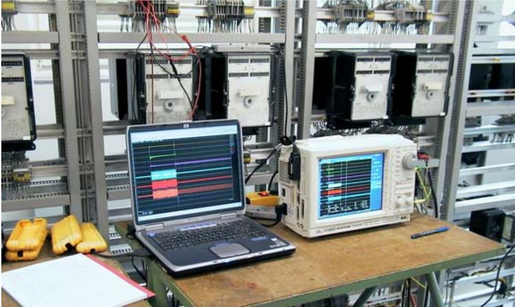
Abbildung 9 Transientenrekorder und portabler Rechner für die Erfassung der Strom- und Spannungsverläufe an den Hochspannungsmesswandlern
