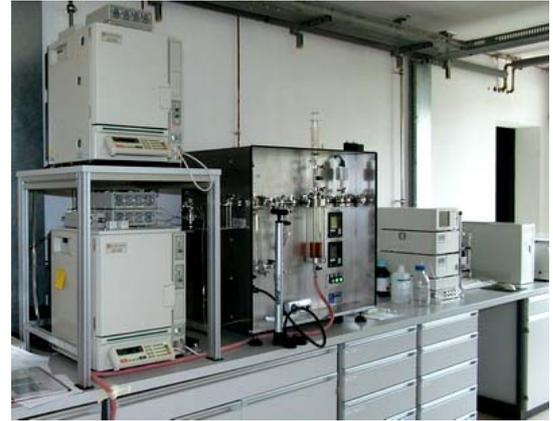
Abbildung 17 Das Herzstück des Isolieröllabors: Die Einrichtungen für Gasextraktion, Zersetzungsgas- und Furananalysen
