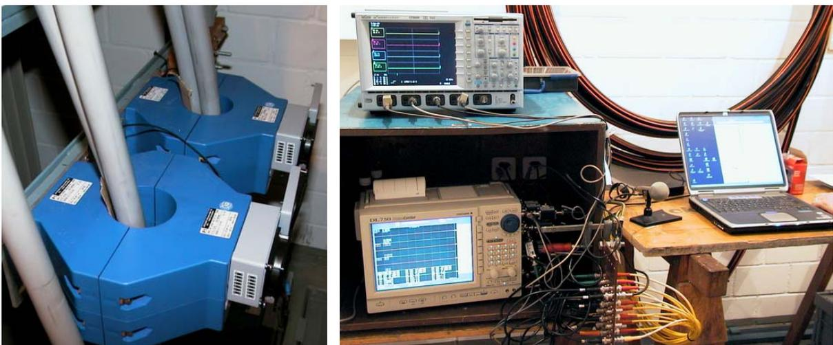
Abbildung 7 Montage der Spezialstromwandler auf der Unterspannungsseite (links) und Oszillographen zur Erfassung der transienten Signale (rechts)
