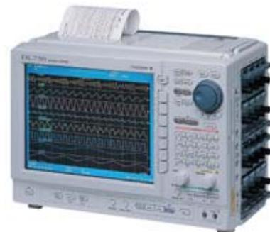
Das Gerät wird als Rekorder zur Messung von Netz- und Schalttransienten aber auch zur mehrkanaligen Darstellung von Teilentladungssignalen eingesetzt.
