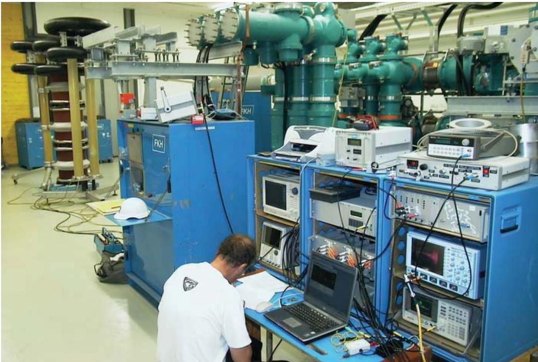
Bild 2 Die älteste GIS der Schweiz wird ersetzt: Hochspannungsprüfung der neuen GIS im Unterwerk Sempersteig in Zürich
