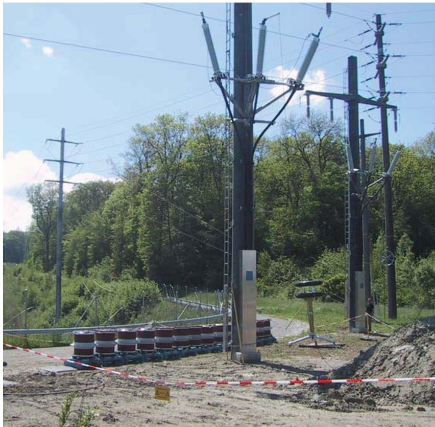
Bild 5 Hochspannungsresonanzprüfung an einer 110-kV-Kabelstrecke mit Einspeisung am Endmast
