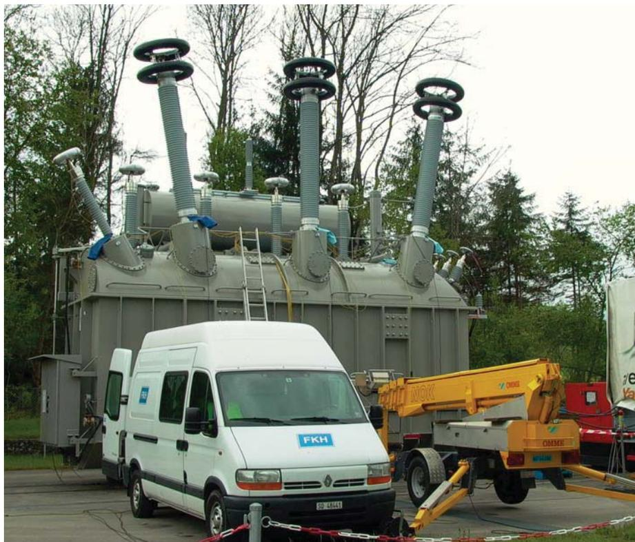
Bild 10 Trafo bei der TE-Messung vor Ort
