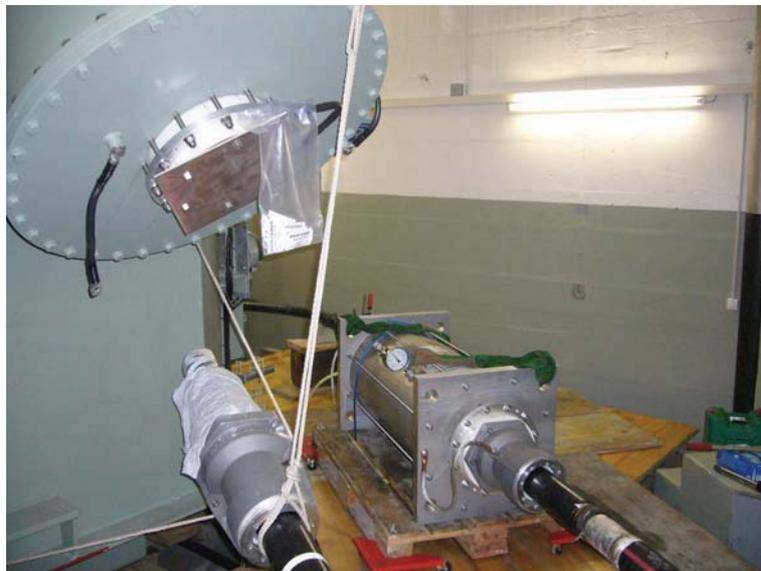
Bild 8 Prüfmuffe mit dem eingesteckten Prüfadapter (hinten) und dem Trafokabel (Prüfobjekt)
