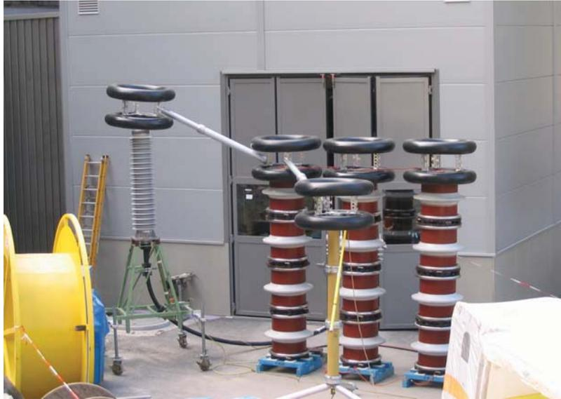
Bild 7 Prüfung der Linienkabel mit der FKH-Resonanzanlage und dem Prüfkabel
