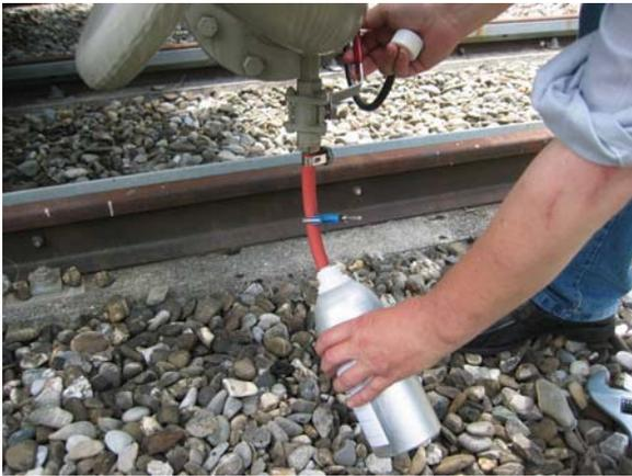
Bild 12 Isolierölprobenentnahme für die dielektrisch-chemische Untersuchung
