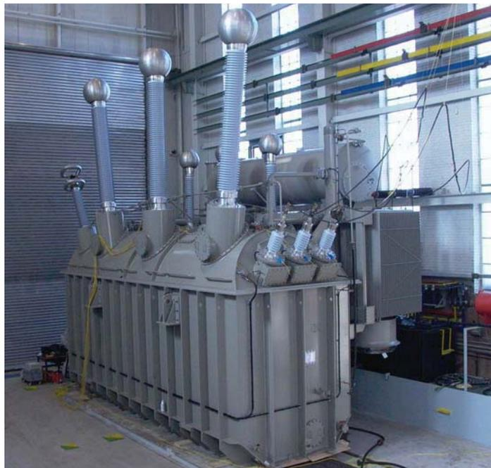
Bild 9 Trafo bei der TE-Messung im Werk
