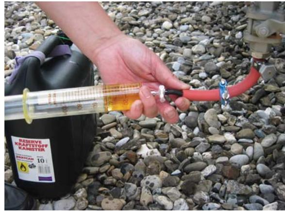
Bild 13 Isolierölprobenentnahme für die Zersetzungsgasanalyse
