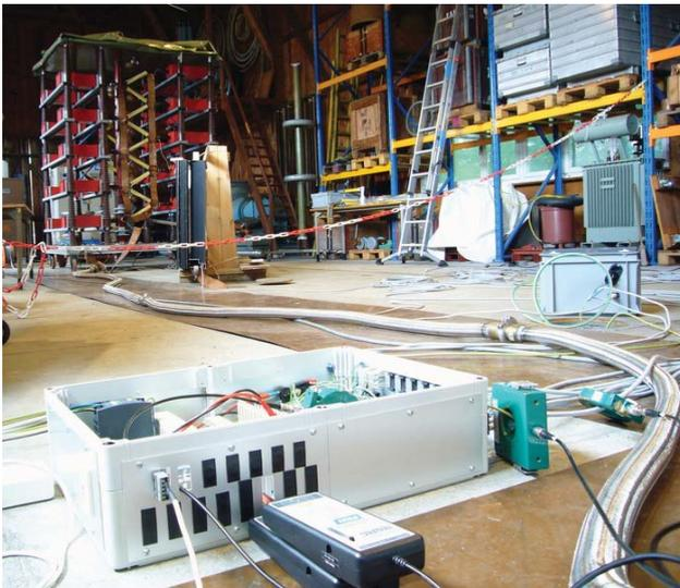
**Bild 6** Übersicht der Versuchseinrichtung mit Stossstromgenerator, Fensterrahmen und Storensteuerung
