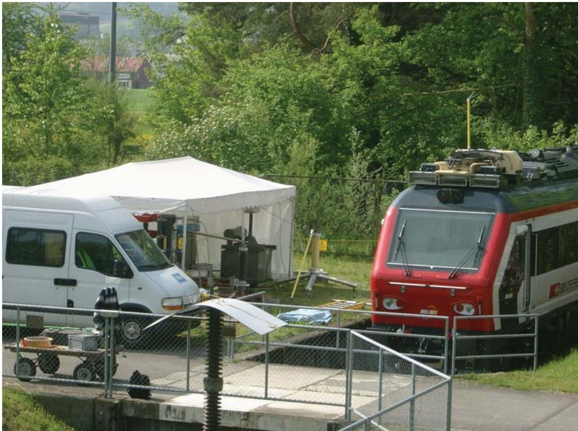
**Bild 5** Spannungsprüfung des Pantographen und der Dachdurchführung eines Messtriebwagens
