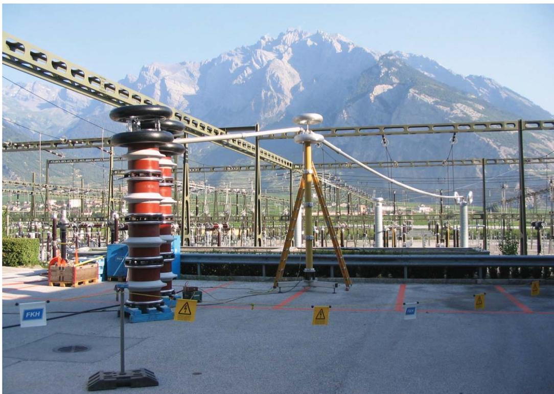
Bild 15 Prüfung einer 275-kV-Kabelverbindung mit TE-Messung im UW Chamoson, Wallis
