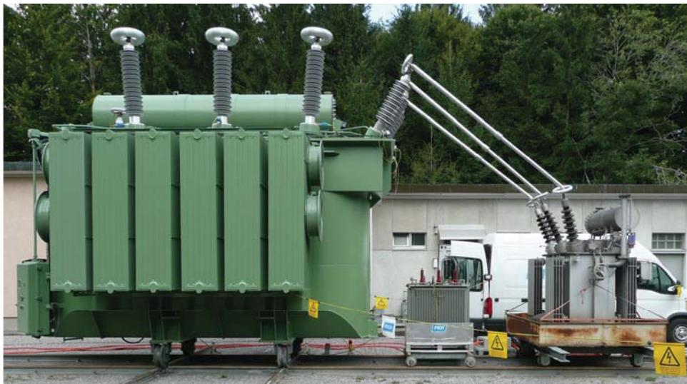
**Bild 7** Vor-Ort-Prüfung 75-MVA-Transformator 132 / 50 kV
