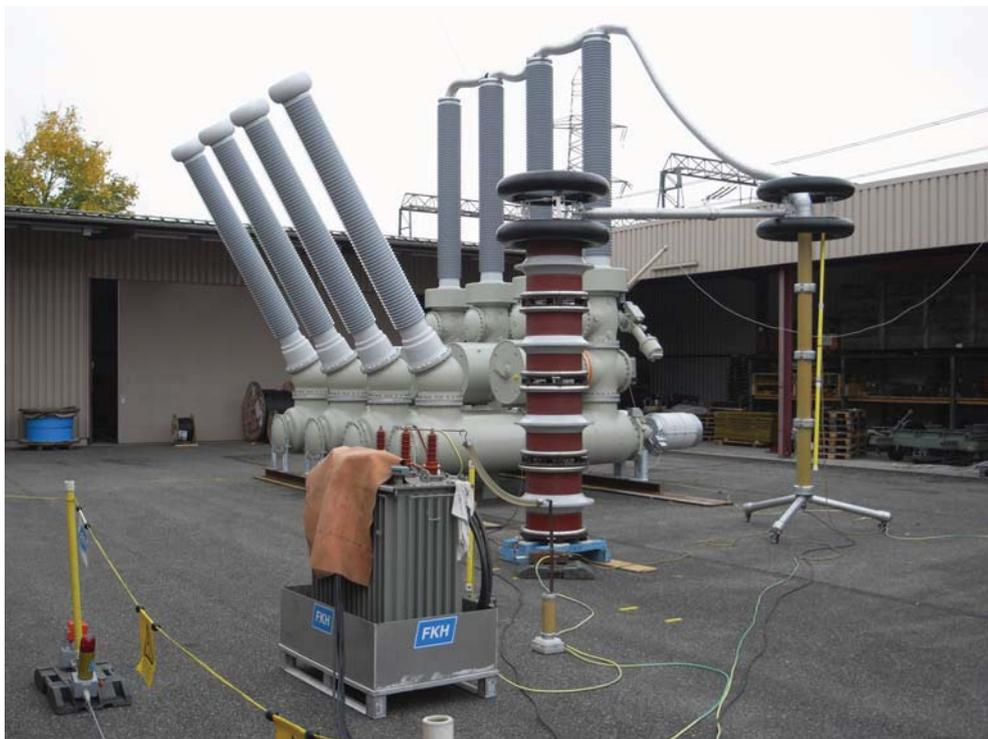
**Bild 5** Parallele Prüfung von 4 Hybrid-Schaltpolen
