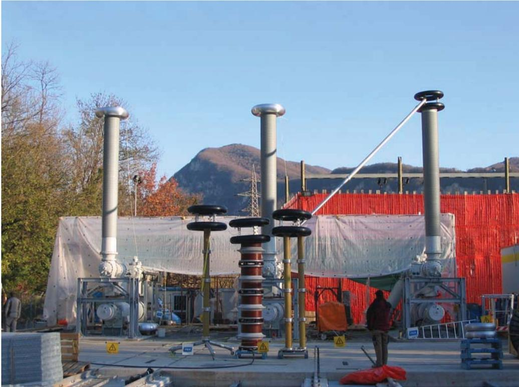
**Bild 6** Prüfung mit TE-Messung eines 400-kV-Schaltfeldes mit Kabelanschluss
