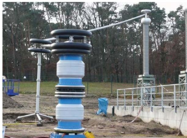
Bild 7 Prüfanlage mit neuen Drosseln
