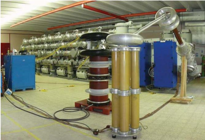
Bild 12 TE-Prüfeinrichtung an einer erweiterten 132-kV-GIS
