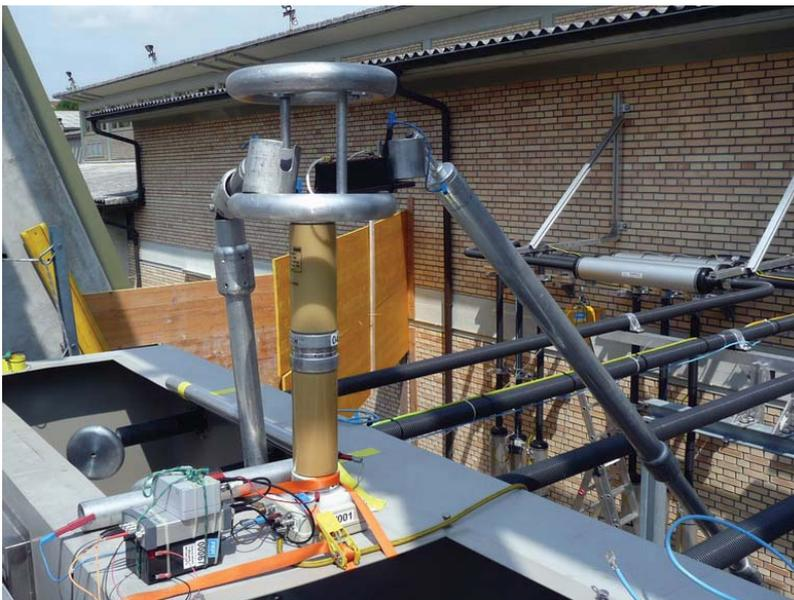
Bild 26 Komplexer Prüfaufbau für die Teilentladungsmessung an isolierten Stromschienenverbindungen einer 22-kV-Mittelspannungsschaltanlage
