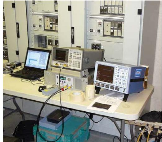
Bild 13 Erweiterte Messausrüstung für die UHF-TE-Erfassung an GIS
