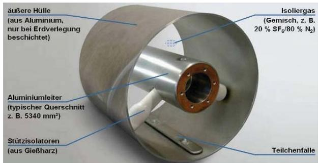
Bild 5 Aufbau einer GIL (Bild Siemens)
