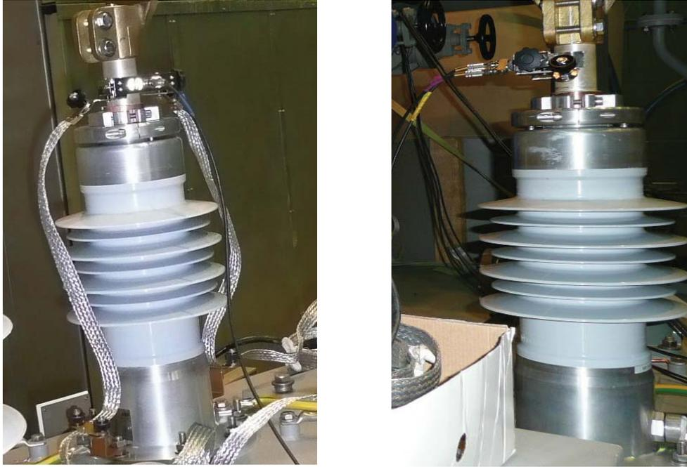
Bild 9 Anschlusstechnik eines Anbieters von FRA-Messgeräten (links: korrekt mit Erdungsbändern; rechts: falsch ohne Erdungsbänder)
