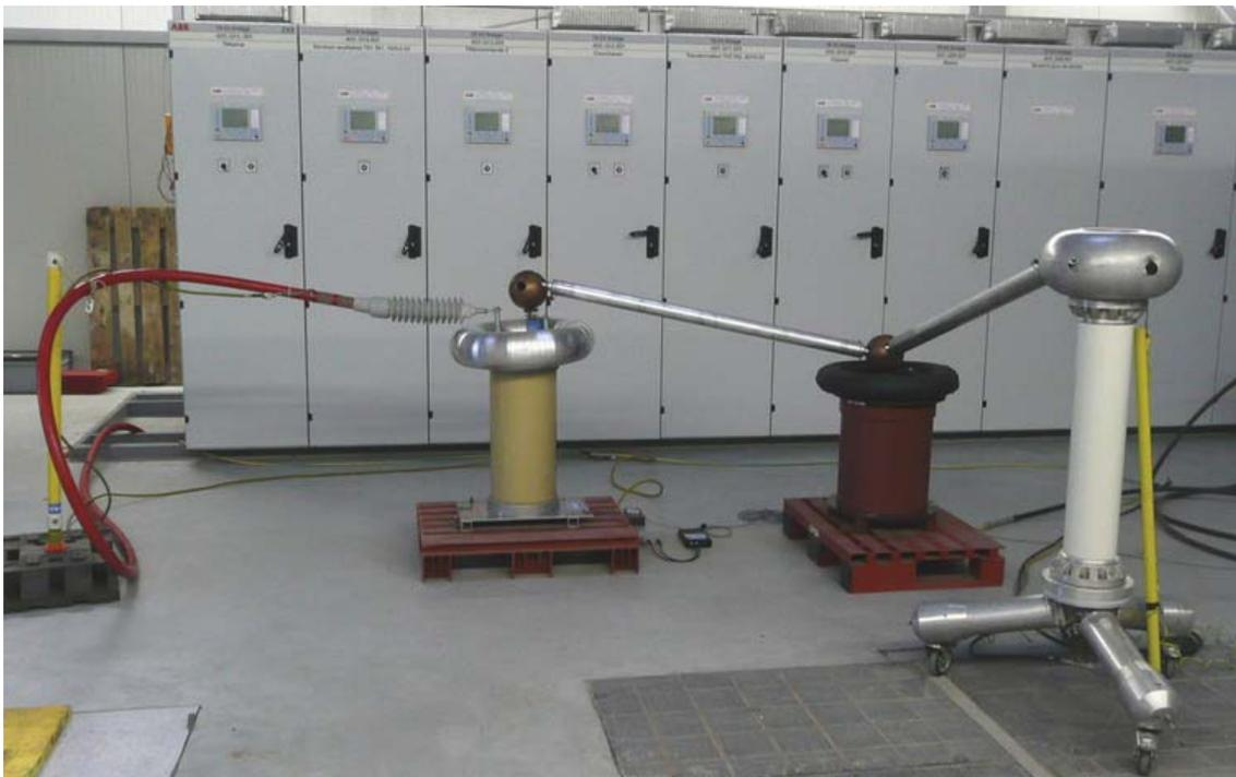
Bild 29 Resonanzprüfung mit Teilentladungsmessung einer 24-kV-Mittelspannungsschaltanlage
