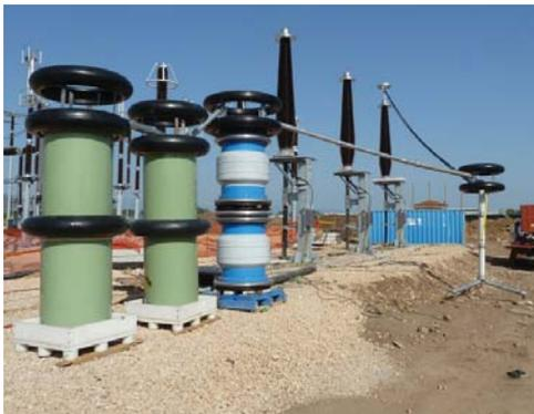
Bild 12 Zwei neue Drosseln Asea Kull DSH 5 in Kombination mit vier zugemieteten Resonanzdrosseln der ABB Schweiz AG
