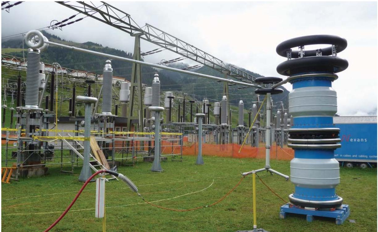
Bild 23 Die zwei ersten Exemplare (Prototypen) der neuen Hochleistungsresonanzdrosseln der FKH im Prüfeinsatz an einer 220-kV-Kabelanlage
