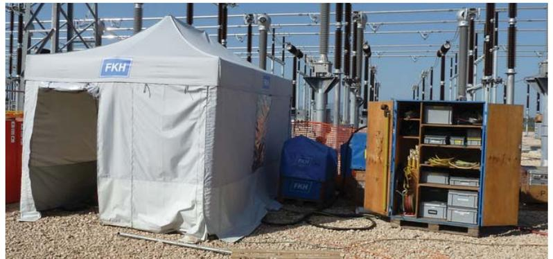
Bild 13 Prüfstand mit Resonanzspeisequelle, Trenntransformator und Zubehorschrank rechts
