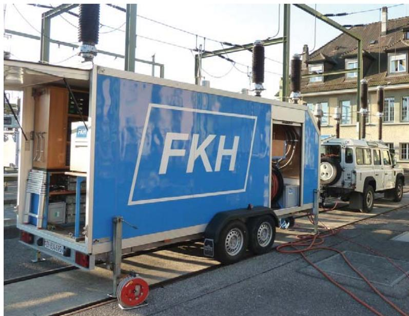
Bild 2 Erdungsmessungen in Unterwerken
