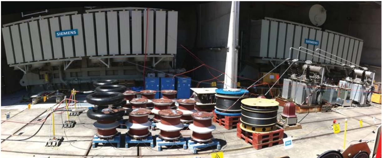
Bild 7 Prüfanlage der FKH vor 2 Polen der Trafobank (rechts: Erregertransformatoren; Mitte: Kompensationsdrosseln)
