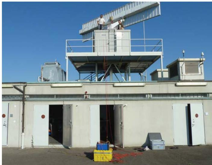
Bild 28 Messung des Blitzschutzpotentialausgleichs an den Flugsicherungsradaranlagen der Skyguide
