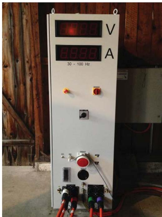
Bild 27: Neuer Steuerschrank für den 1-MV-Prüftransformator
