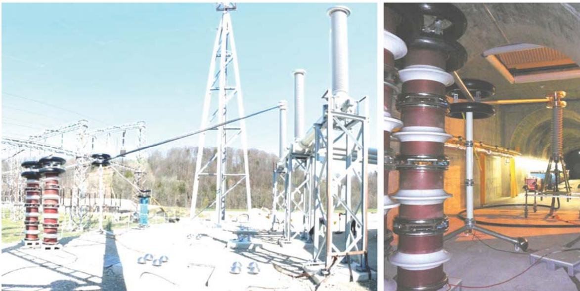
Aufbau im Freien für eine Prüfspannung von 515 kV an einer 420 kV GIS (Ur)
