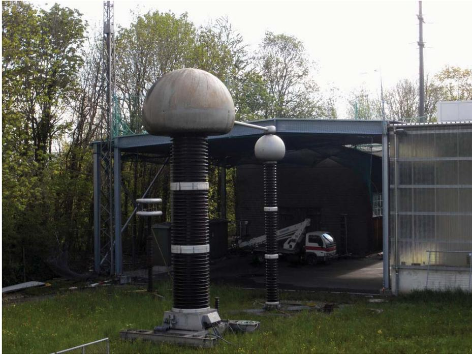
Bild 26: 1000-kV-Prüftransformator, Moser - Glaser AG
