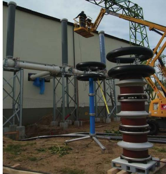
Bild 12: Kapazitiver Spannungsteiler und Drosselturm. Der Arbeiter auf der Hebebühne installiert das Kabel zwischen Teiler und Freileitungsdurchführung
