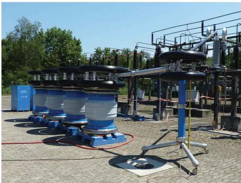
Bild 5: Hochspannungsresonanzprüfung einer 110-kV-Kabelstrecke
