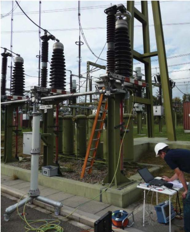
Bild 15: Vor-Ort-TE-Messversuche an einem Kabelendverschluss ohne Koppelkondensator
