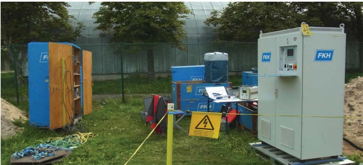
Bild 13: FKH Prüfanlage mit Frequenzumrichter (am rechten Bildrand)
