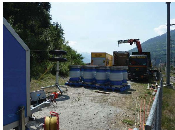
Abbildung 3: Prüfaufbau Spannungsteiler und Resonanzdrosseln. Hinten: LKWs mit zwei Frequenzumrichtern
