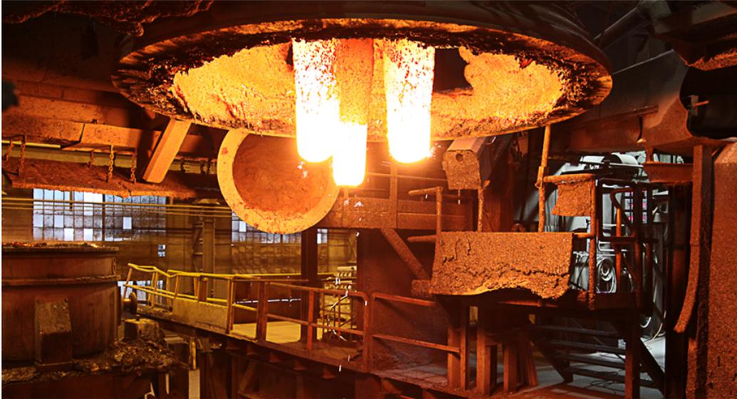
Glühende Elektroden eines Lichtbogen-Ofens (Quelle: Stahl Gerlafingen)
