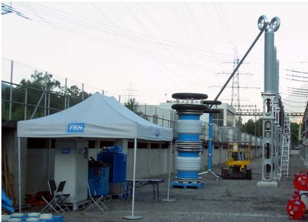
**Bild 2** Vor-Ort-Serieresonanzprüfung an einer 275-kV-Kabelverbindung mit Teilentladungsmessungen an den Kabelendverschlüssen. Der kapazitive Spannungsteiler dient auf dem sichtbaren Kabelende gleichzeitig als Koppelkondensator.
