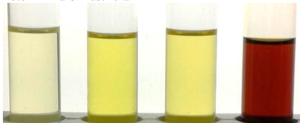
Bild 8: Farbe und Erscheinen der Öle Shell Diala S4 ZX-I (GtL), Nynas Nytro 4000X, Shell Diala S3 ZX-I und Shell Diala D (v.l.n.r.) nach 35 Tagen Alterung unter Abschluss von Luftsauerstoff.
