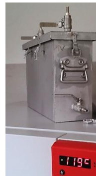
Bild 2: Edelstahlbehälter zur Öl- und Papieranalterung
