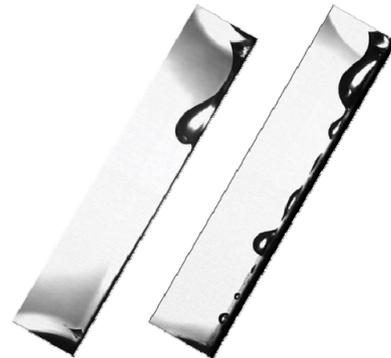
Abbildung 5: Seitenansicht eines hydrophoben (links) bzw. teilhydrophilen (rechts) Isolierstoffes
