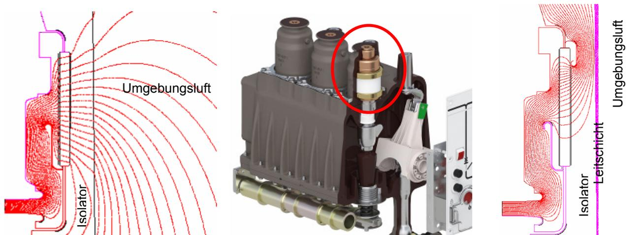
**Abbildung 4:** Einfluß der Oberflächenschirmung auf die elektrische Feldverteilung am Beispiel des Vakuumleistungsschalters (VI). Modelldarstellung mit aufgeschnittener Ansicht des VI (mitte). Bei (hybrider) SIS Isolierung (links) zeigen die Feldlinien die Spannungsbelastung des Außenraumes an. Bei SSIS bewirkt die Schirmung einen feldfreien Außenraum.
