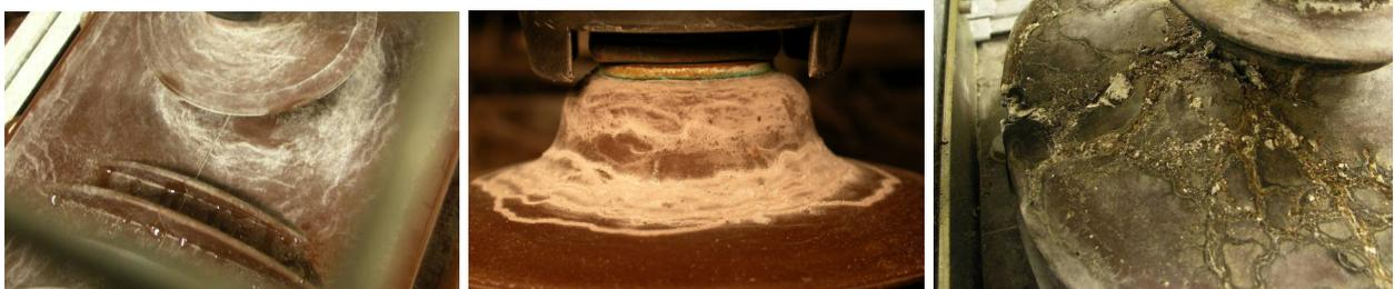
**Abbildung 3:** Alterung einer Feststoffisolierung durch Ionisation am Trielpunkt in erschwerter Umgebung. Anfangsstadium mit erodiertem Epoxid und freiliegendem Füllstoff (links), fortgeschrittenes Stadium (mitte), und Endresultat mit starker Schädigung durch Kriechströme und Überschläge (rechts)
