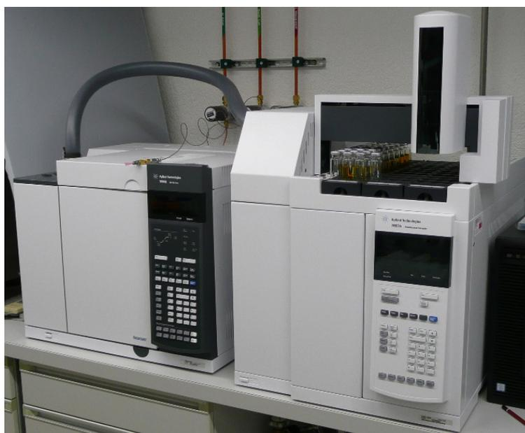
Abbildung 1 Neues Messsystem für die Zersetzungsgasanalyse mit Probengeber rechts und Gaschromatograph links
