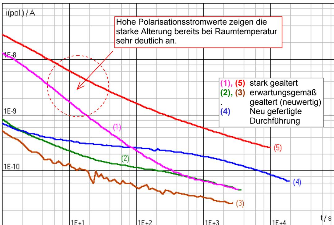
**Abbildung 10** Untersuchung des Alterungszustandes von betriebsgealterten 420-kV-Öl-Papier-Durchführungen mit PDC-Messungen bei Raumtemperatur. Fortgeschrittene Alterung ist an stark erhöhten Anfangswerten des Polarisationsstromes erkennbar.
