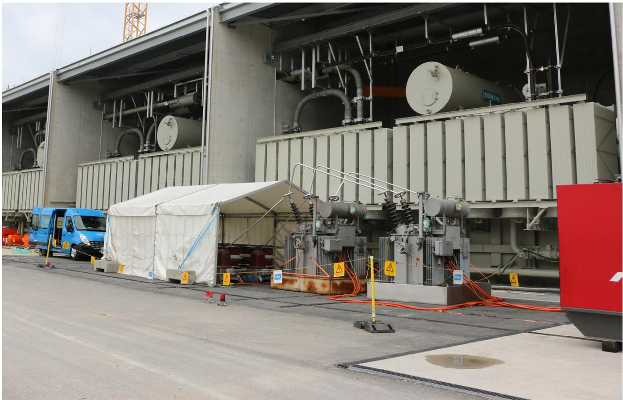
Abbildung 17 Induzierte Spannungsprüfung mit Teilentladungsmessung an einer 800-MVA-Phasenschieber-Transformatorbank
