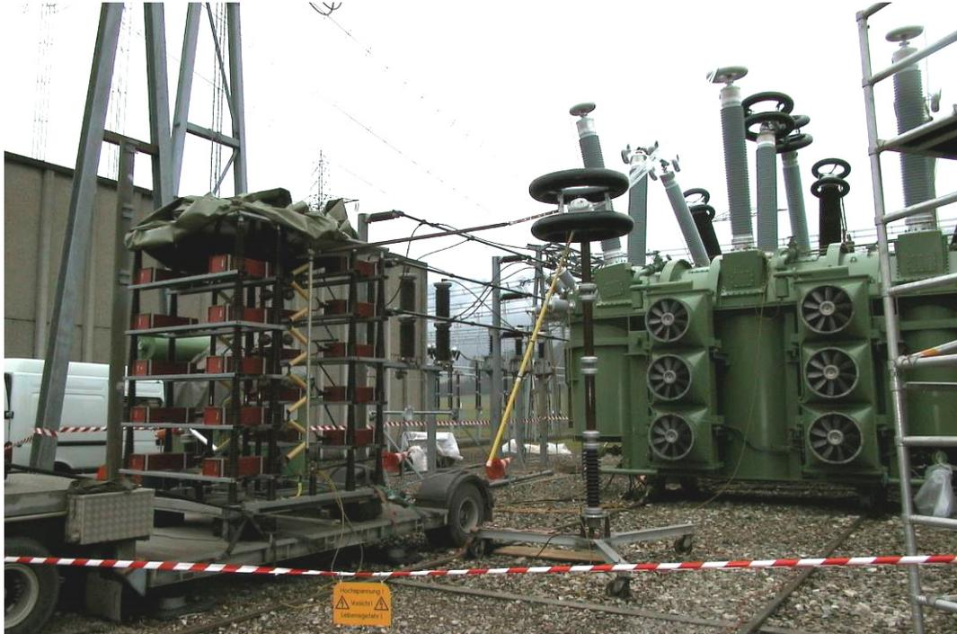
Abbildung 29 Mobiler Stossgenerator bei der Prüfung eines 400-MVA-Transformators.
