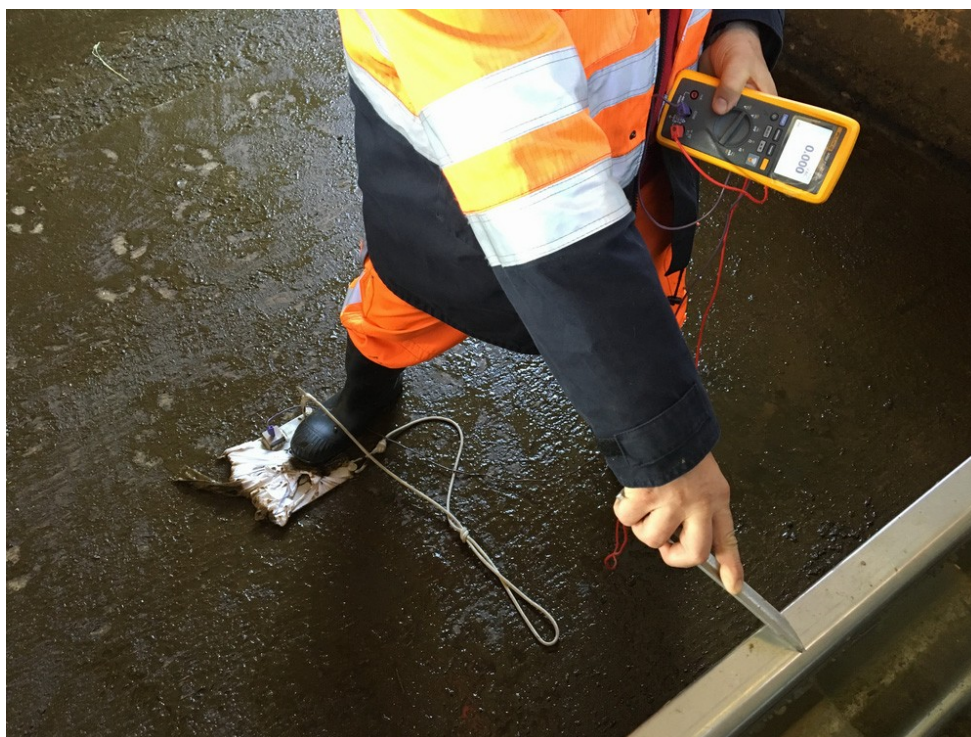
Figure 2 Mesure de la différence de tension alternative entre la surface où se tient un bovin et un abreuvoir métallique. Possibilité simple de mise en contact du sol en béton à l'aide d'une plaque métallique enveloppée dans un chiffon mouillé. Lors de cette mesure, la distance correspond environ à celle de l'abreuvoir jusqu'aux pattes avant.
