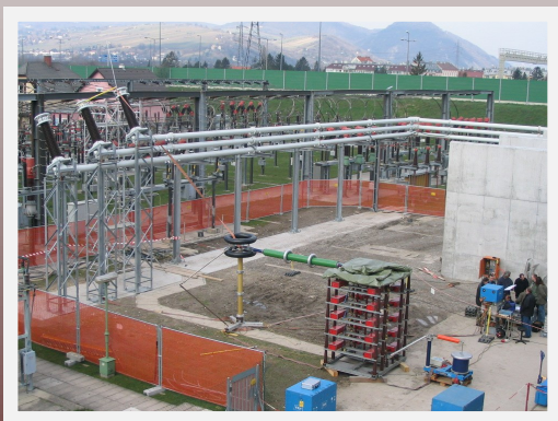
Essai d'un PSEM 123 kV avec un essai de choc oscillant
