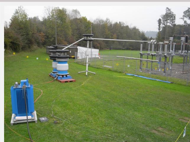
Installation d'essai de câbles dans une sous-station extérieure
