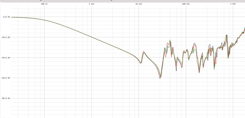
Mesure de FRA sur un transformateur triphasé
