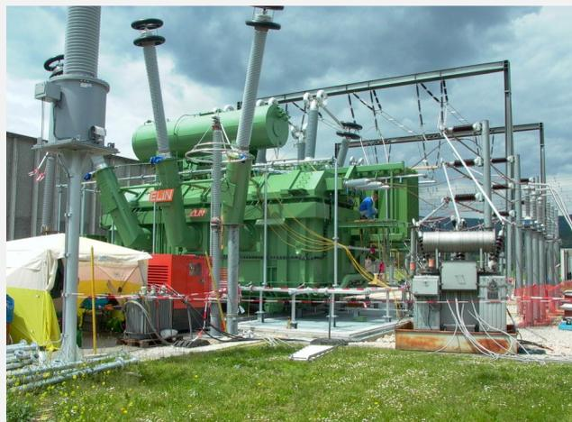
Mesure de décharges partielles sur un transformateur de couplage du réseau dans une sous-station. Excitation à l'aide d'un générateur diesel
