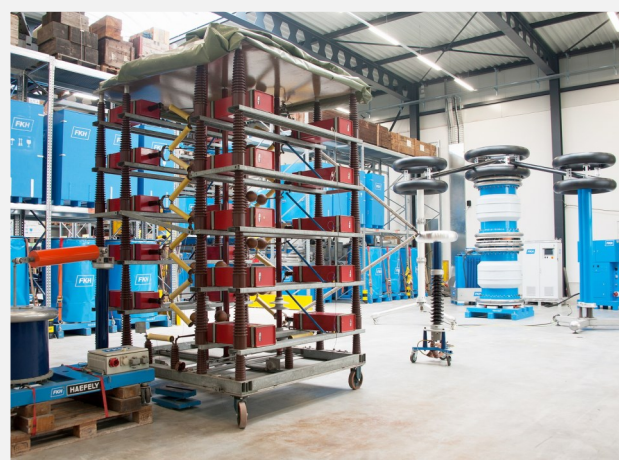
Système mobile d'essai : générateur de choc haute-tension et système d'essai résonant série (en arrière-plan)
