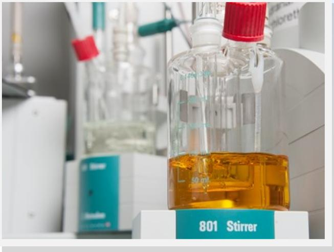
Bestimmung des Wassergehalts im Isolieröl mittels Karl-Fischer-Titration
