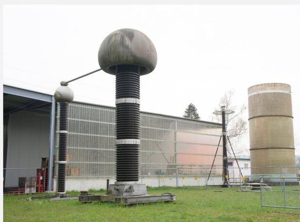
1000-kV-Prüftransformator in der Versuchsstation Däniken
