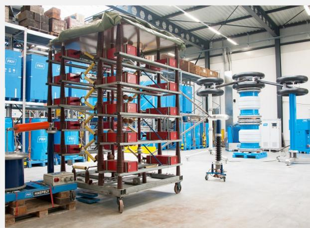
Mobile Prüfanlagen: Stossgenerator, Serieresonanzanlage
