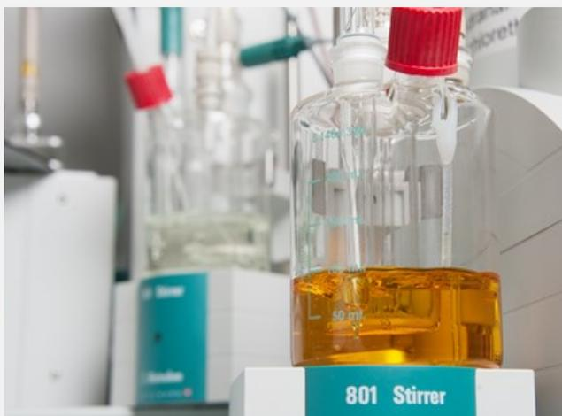
Détermination de la teneur en eau dans l'huile isolante au moyen de la méthode de Karl Fischer
