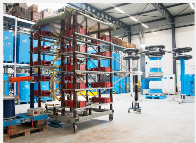
Mobile Prüfanlagen: Stossgenerator, Serieresonanzanlage
