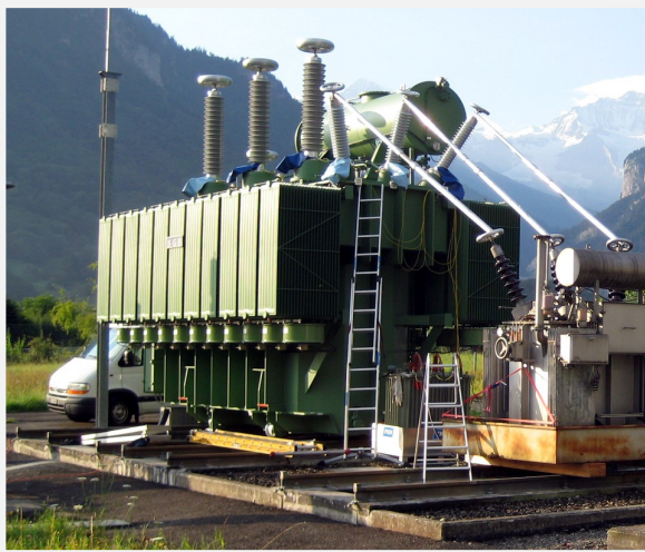
Erregung eines Netz-kuppeltransformators für die Teilladungsmessung im Unterwerk
