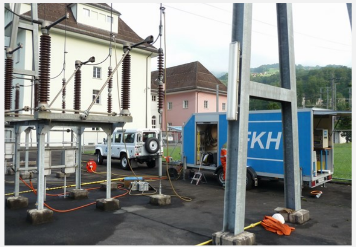
Erdungsmessanlage: Einspeisung eines Prüf-Erdschlussstromes in eine Freileitung im Unterwerk
