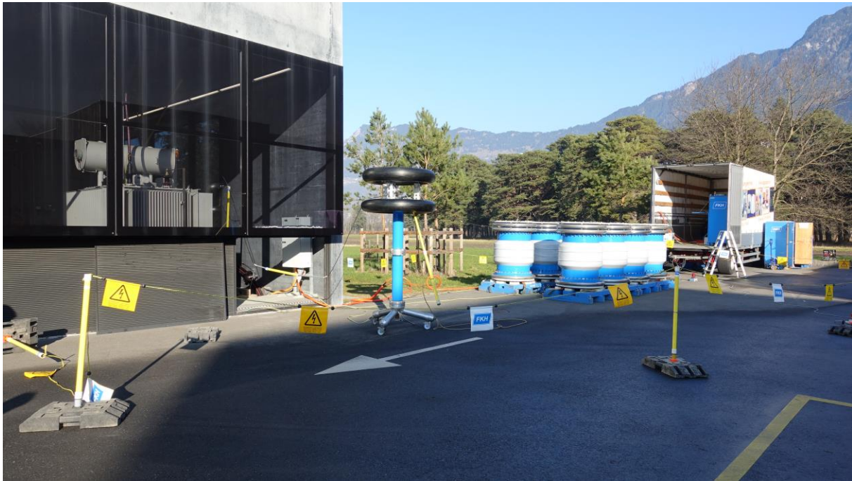
Abbildung 1: Absperrung der Prüfanlage mit Warnfahnen-Kordeln
