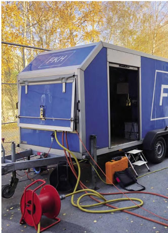
Abbildung 6: Elektronische Quelle zur Einspeisung eines Messstroms in das Hochspannungskabel
