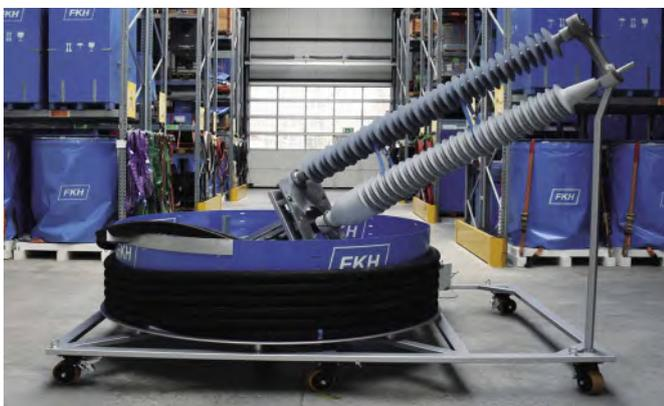
Abbildung 1: Prüfadapterkabel Freiluftendverschluss – Connex Gr. 5, 145 kV
