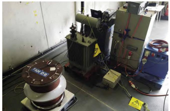
Abbildung 7: Generatorprüfung mit Prüftransformator und Kompensationsdrossel
