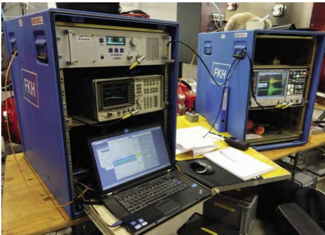
Abbildung 3: UHF-TE-Messsystem der FKH inklusive Laufzeitmessung zur Ortung von TE
