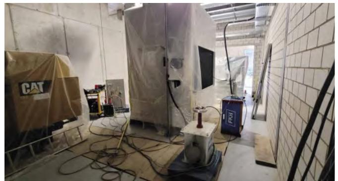
Abbildung 6: Prüfung mit Prüftransformator bis 50 kV
