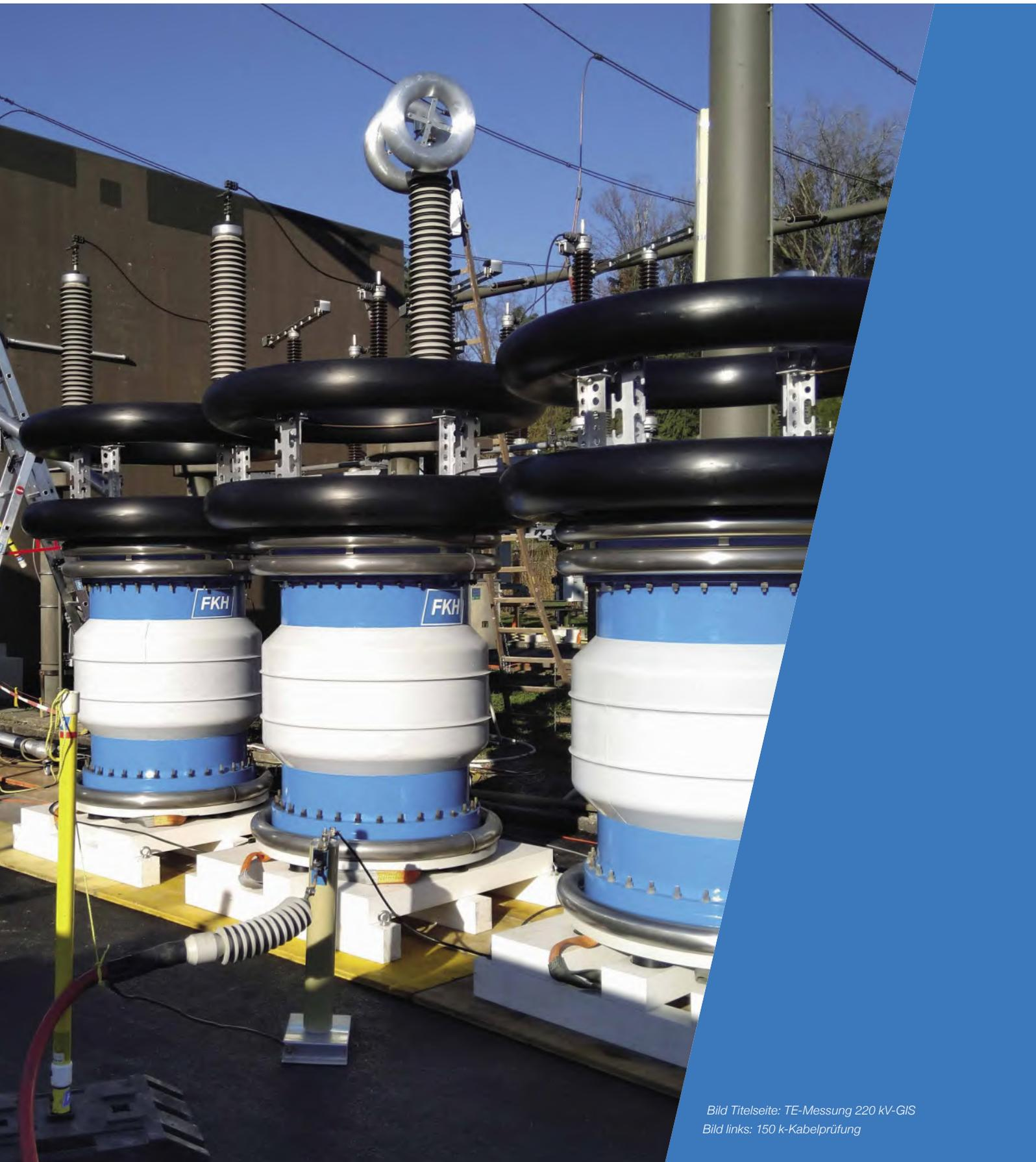
Bild Titelseite: TE-Messung 220 kV-GIS
