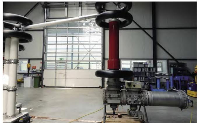
Abbildung 3: Prüfadapterkabel Freiluftdurchführung – Connex Gr. 6, 170 kV
