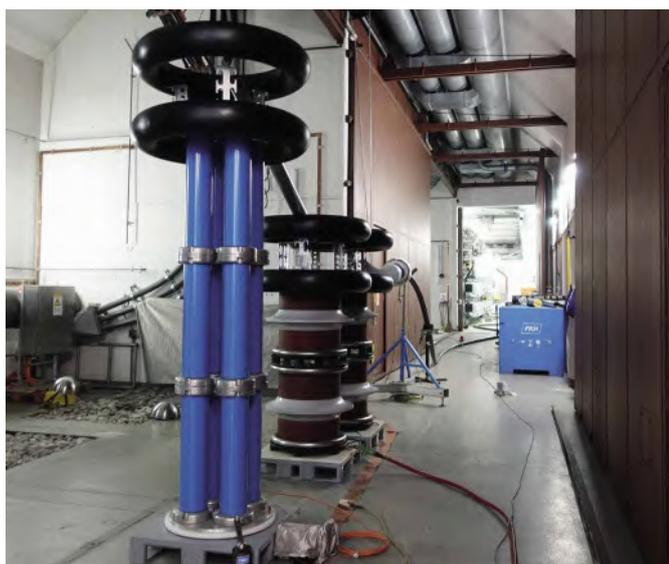
Abbildung 3: Resonanzprüfanlage mit Prüfkabeladapter
