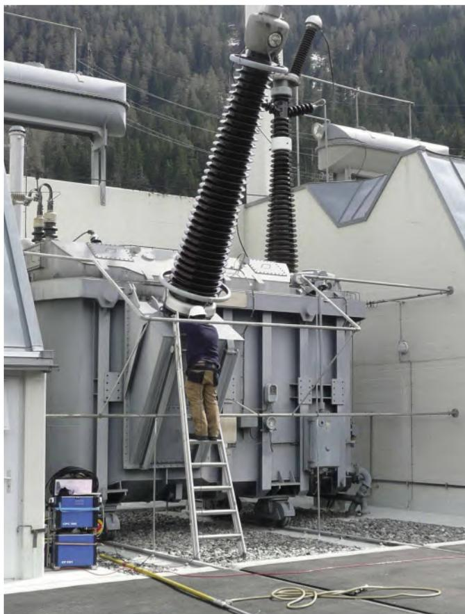
Abbildung 1: Messung des Verlustfaktors und der Kapazität an der Durchführung eines 420 kV-Maschinentransformatorpols
