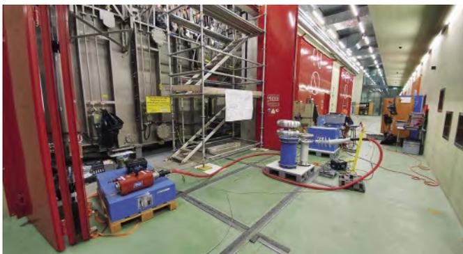
Abbildung 3: Resonanzkreis mit 40-H-Drossel bis 60 kV
