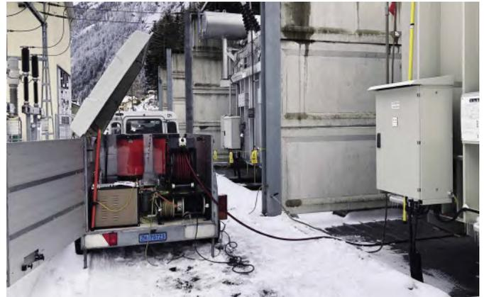
Abbildung 5: Serie-Resonanzquelle mit 40–60 Hz für kleinere Prüfungen auf Anhänger
