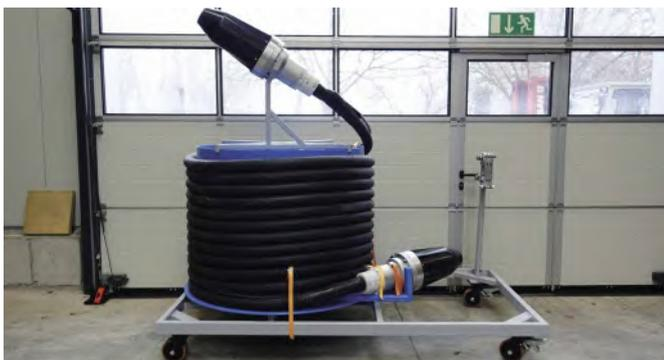
Abbildung 2: Prüfadapterkabel Connex Gr. 6 – Connex Gr. 6, 245 kV
