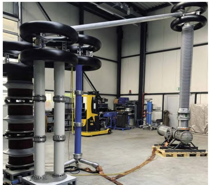
Abbildung 4: Prüfadapterkabel Freiluftdurchführung – Connex Gr. 6, 245 kV
