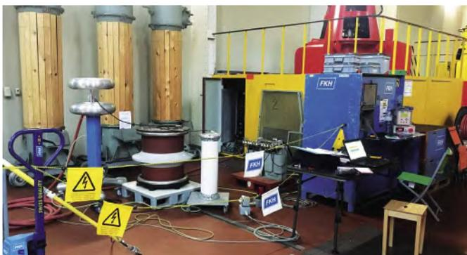
Abbildung 4: Resonanzkreis mit 50-H-Drossel bis 150 kV
