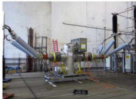
Schalter mit IPO während Leistungsversuchen
