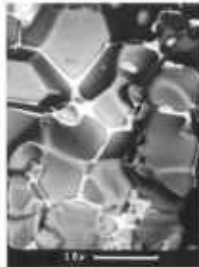
REM bild der Bruchkante eines MO-Widerstandes
