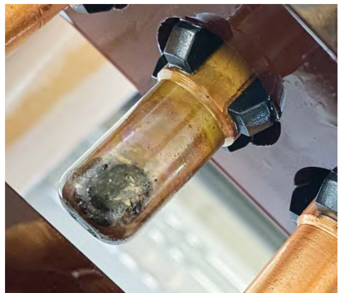
Abbildung 1: Überhitzter Kontakt der Stellung 3
