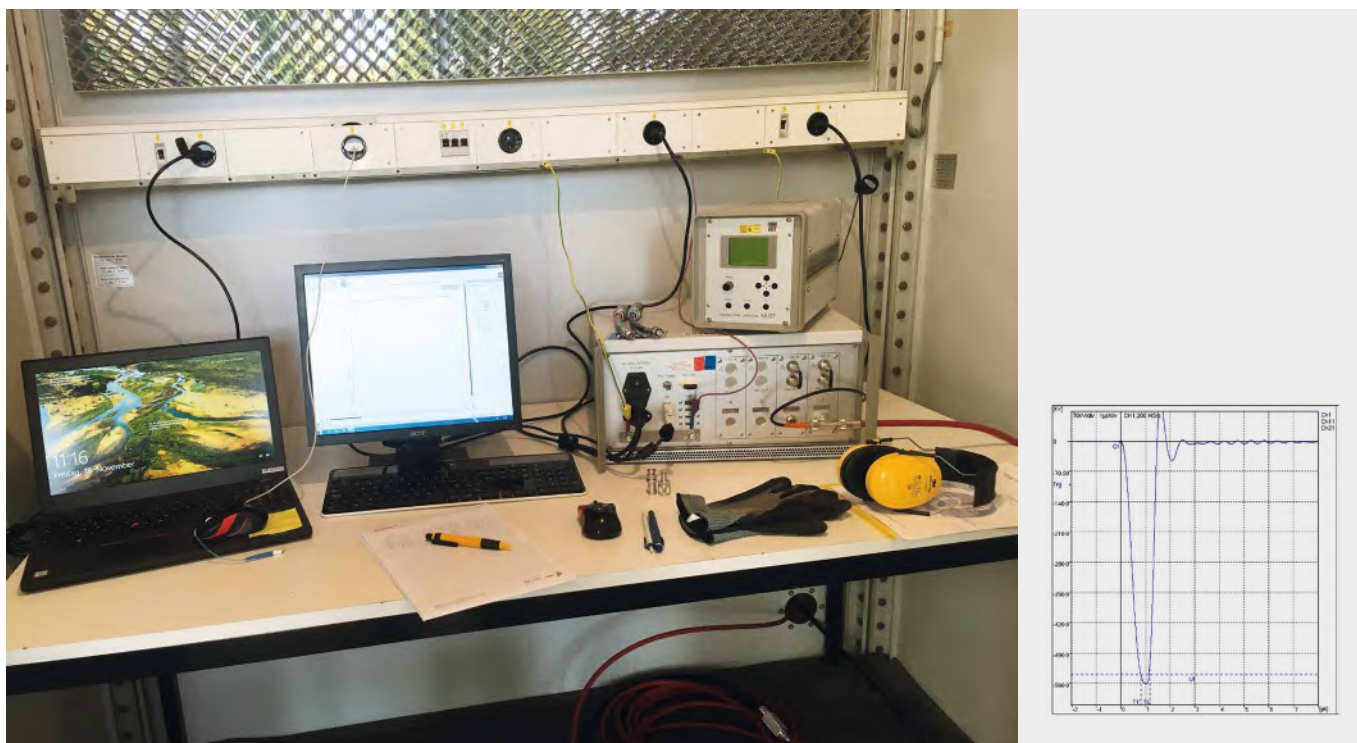
Abbildung 3: links: Auswertung der Parameter der Stossspannung mit einem Auswertesystem, rechts: registrierte, im Rücken abgeschnittene Stossspannung
