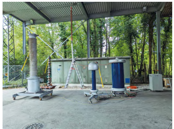
Abbildung 2: Versuchsanordnung für die Messungen am Ferroresonanzkreis
