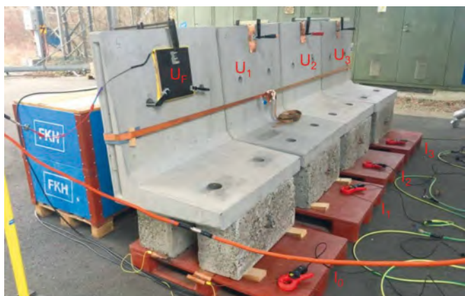
Abbildung 2: Versuchsaufbau für die Messung der Potenzialverteilung auf 4 aneinandergereihten Fertigbeton-Winkeln
