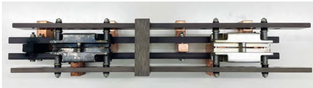
Abbildung 2: Verkohelter und intakter Kontakt
