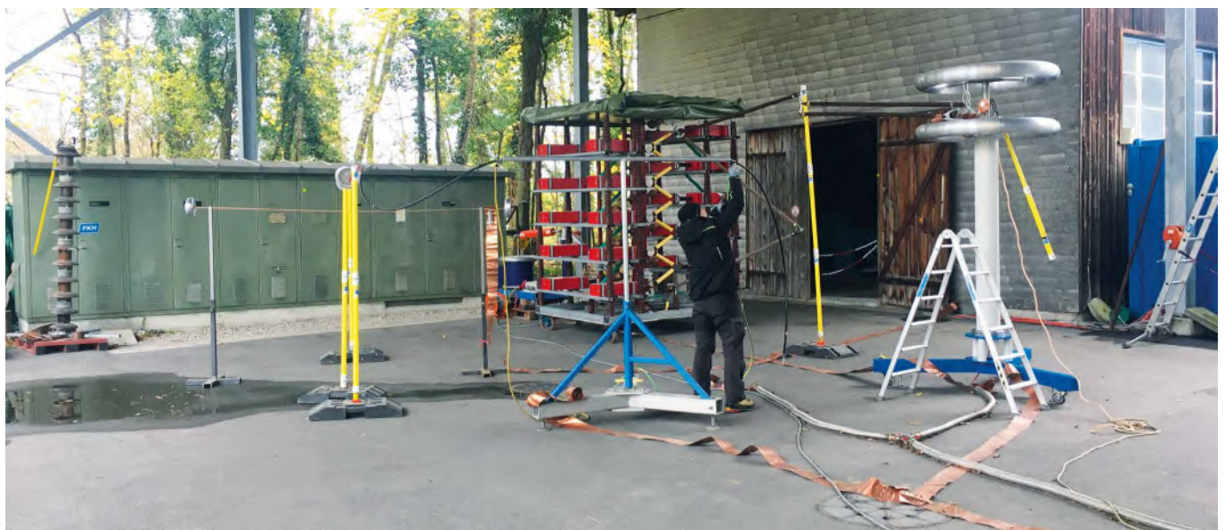
Abbildung 2: Versuchsanordnung aufgebaut in der FKH-Versuchsstation in Däniken, mobiler 800-kV-Stossgenerator im Hintergrund, im Vordergrund v.l.n.r.: Vergleichsanordnung, Metallrohr für die Einfädung des Prüflings, Stossteiler
