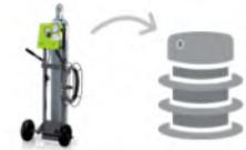
Füllen von vorgemischten teilverflüssigten Gemischen. Das Gemisch in der Flasche ist nicht homogen. Durch die Speicherung im teilverflüssigten Zustand kann eine größere Menge effizient in Flaschen gespeichert werden.
