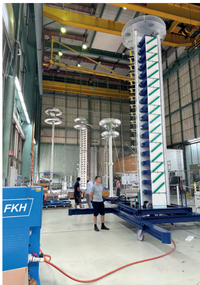
Abbildung 2: Werkabnahme des komplett aufgebauten 1'800-kV-Stossgenerators. Die Anlage wurde auf dem erweiterten Grundrahmen aufgebaut.
