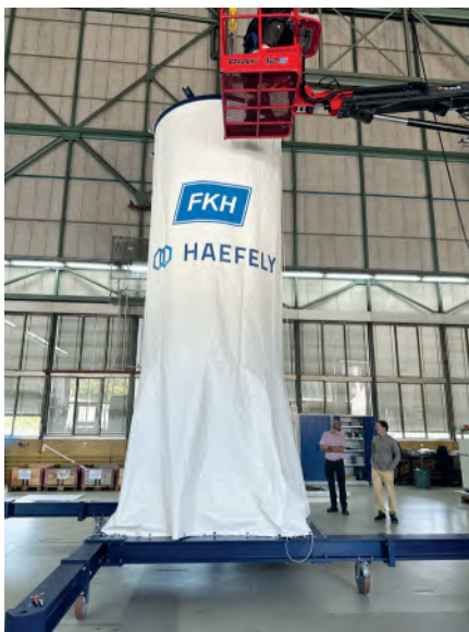
Abbildung 3: Speziell angefertigte Planen zur Abdeckung des Stossgenerators mit verschiedenen Stufenzahlen
