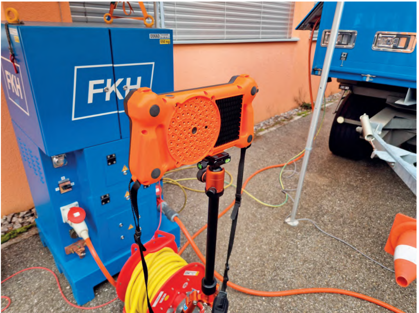
Abbildung 4: Mikrofonmatrix an der akustischen Kamera
