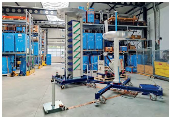
Abbildung 7: Abnahmetest in der FKH-Versuchsstation mit verschiedenen Lastkondensatoren
