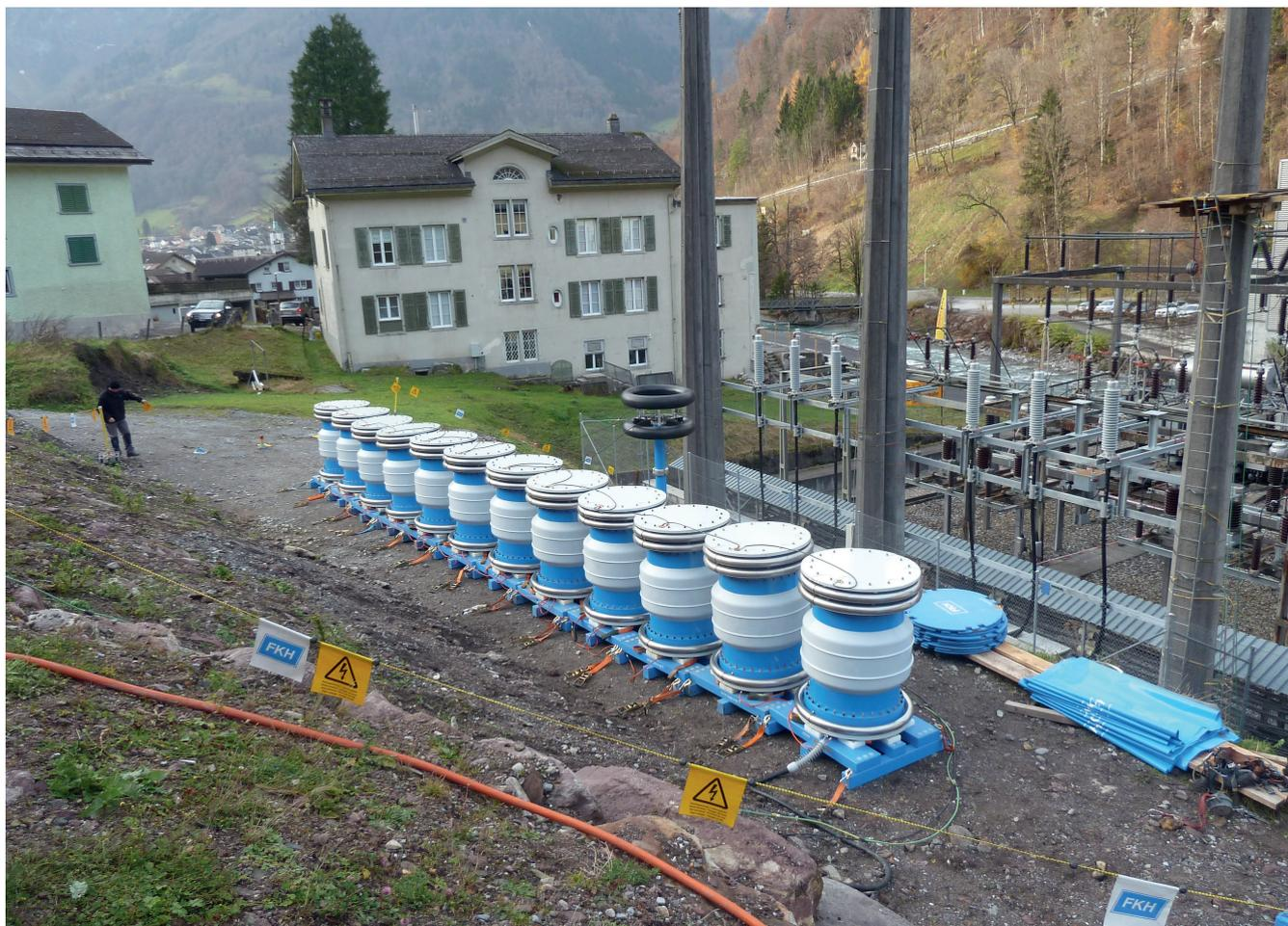
Kabelprüfung an einem 110-kV-Kabelsystem.
