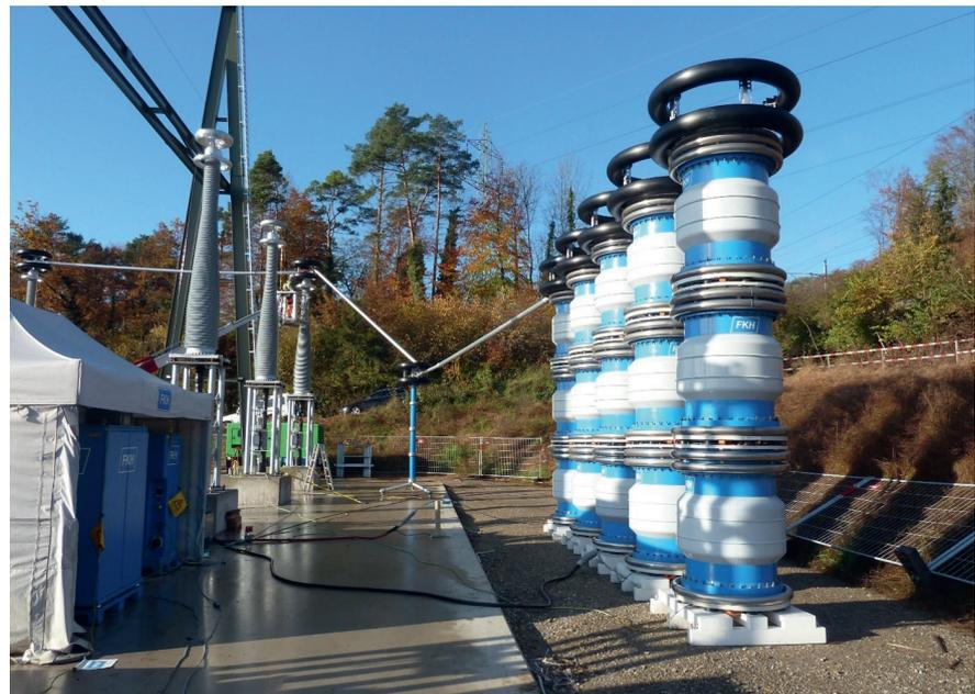
**Bild 1** Beispiel einer Kabelprüfung durch die FKH an einem 380-kV-Kabelsystem.
