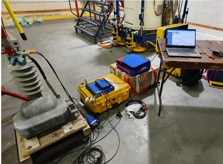
Abbildung 5: Frequenzgangmessung an einem Spannungswandler in Kanada / Hydro Quebec
