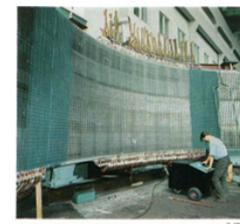
Bild 5. Prüfen einer Maschinenwicklung mit dem Niederfrequenz-Prüfgerät.
