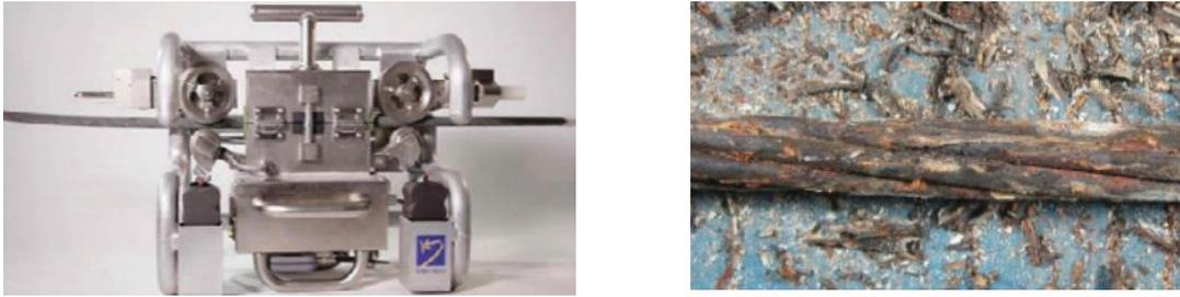
**Abbildung 2: Mobiles System zur Messung des Querschnitts des Stahlkerns (links) und korrodiertes Stahlkern, [19]**
