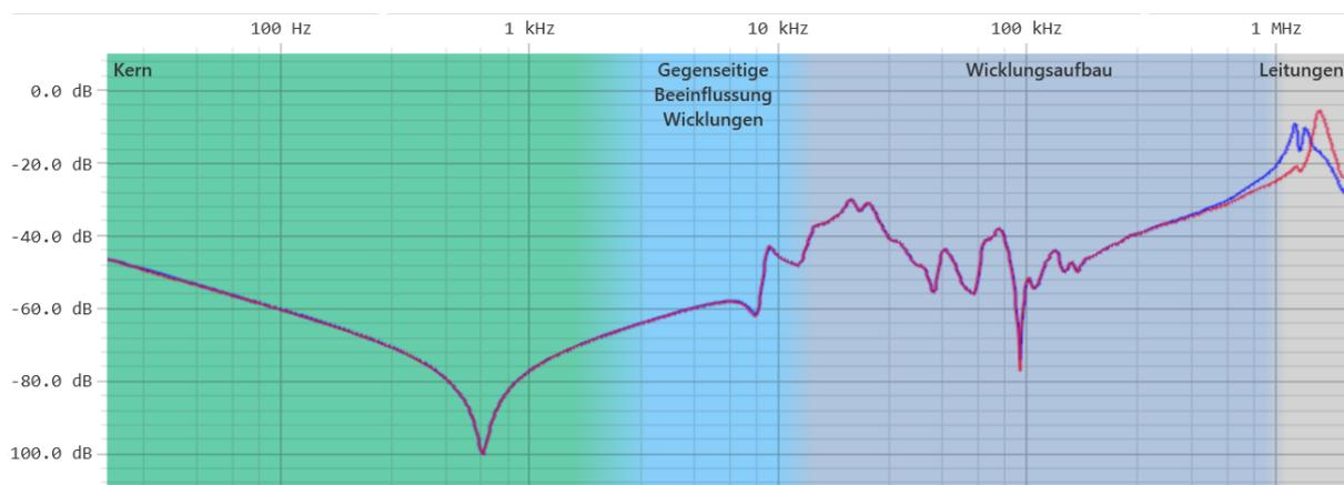
**Abbildung 8:** Typische Einflüsse bei einer FRA-Messung (Quelle: PTM Omicron).
