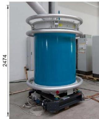
400 kV Prüfsystem, 40 mA
