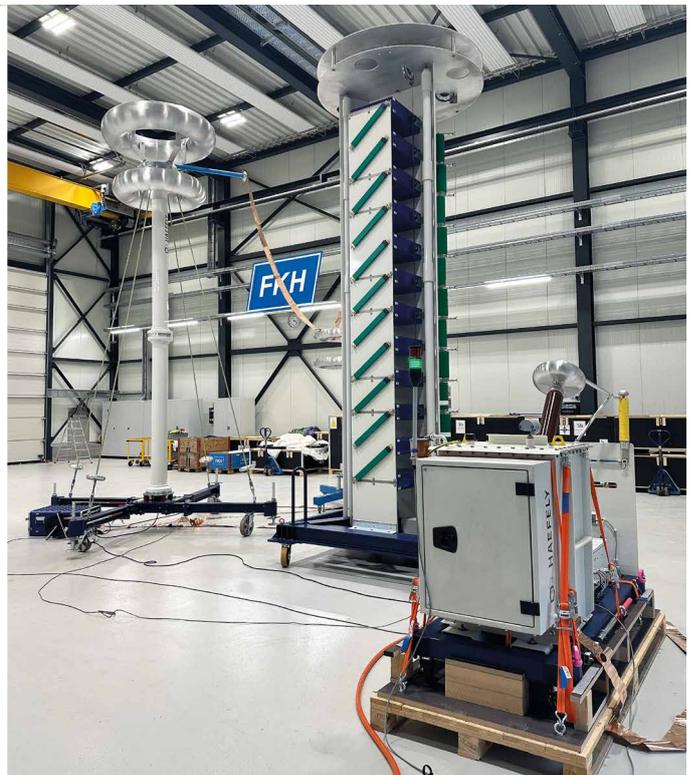
Abbildung 2: 12-stufig aufgebauter Stossgenerator mit Ladeeinheit und zwei Spannungsteilern
