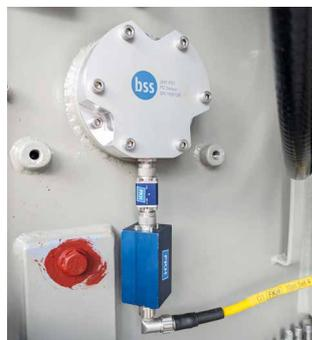
Abbildung 4: externer UHF-Sensor inkl. Verstärker und UHF-Kabel zur Teilentladungsmessung
