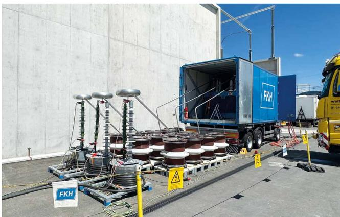
Abbildung 1: mobile Transformatorprüfanlage inkl. Kompensationsdrosseln (4x 50-H-Drossel parallel pro Phase in Sternschaltung)
