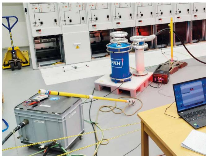
Abbildung 4: Prüfung einer 20-kV-Schaltanlage mit der kleinen 40-H-Drossel
