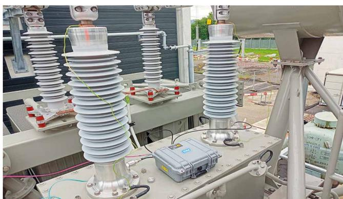
Abbildung 3: Teilentladungsauskopplung an Durchführungen der Unterspannung über ein zweikanaliges MPD800-System (im Hintergrund: Überspannungsableiter, die mitgeprüft wurden)
