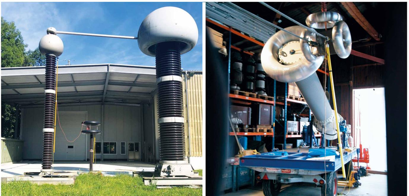
Abbildung 5: 1-MV-Moser-Glaser-Prüftransformator mit Spannungsteiler (links). Gasisolierter 400-kV-Trench-Prüftransformator (rechts)
