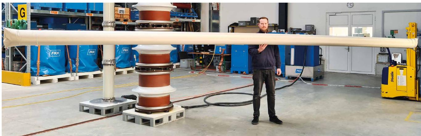
Abbildung 4: Versuchsmuster des aufblasbaren Hochspannungsleiters mit 7 m Länge, 20 cm Durchmesser und 1.5 kg Gewicht (getragen durch Simon Mutter; Mitentwickler)
