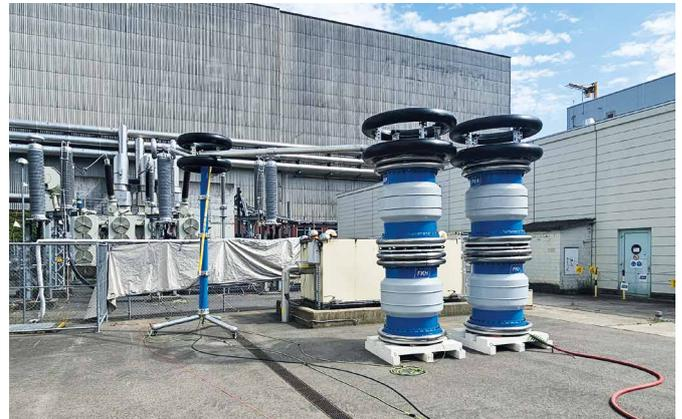
Abbildung 2: Prüfanlage mit Teiler und Drosseln (von links nach rechts) mit abgeschirmtem Zaun im Hintergrund
