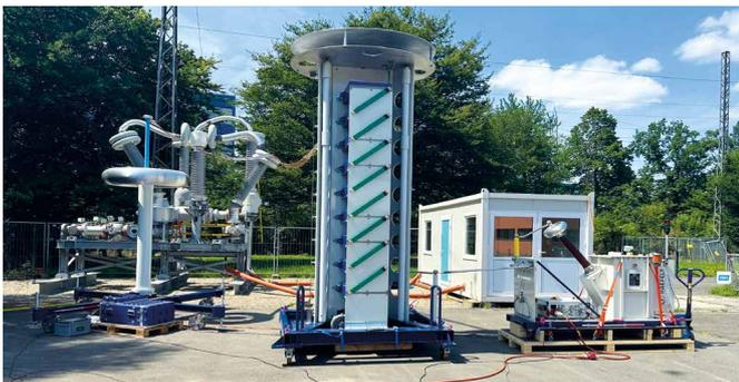
Abbildung 1: Prüfling (hinten links), Teiler (vorne links), Stossgenerator (Mitte), Ladeeinheit (vorne rechts), Container (hinten rechts)
