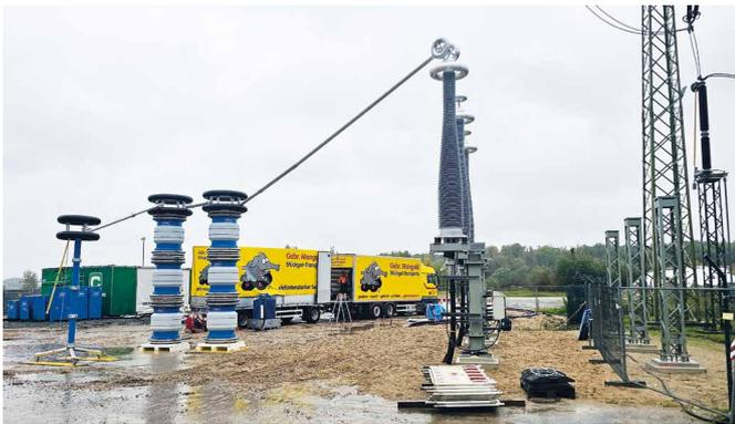
Abbildung 1: Prüfanlage für eine 220 m lange 380-kV-Leitung
