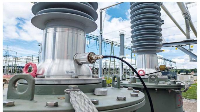
Abbildung 2: Beispiel für die Teilentladungsaukopplung mithilfe von Adaptern an den verbauten Durchführungen
