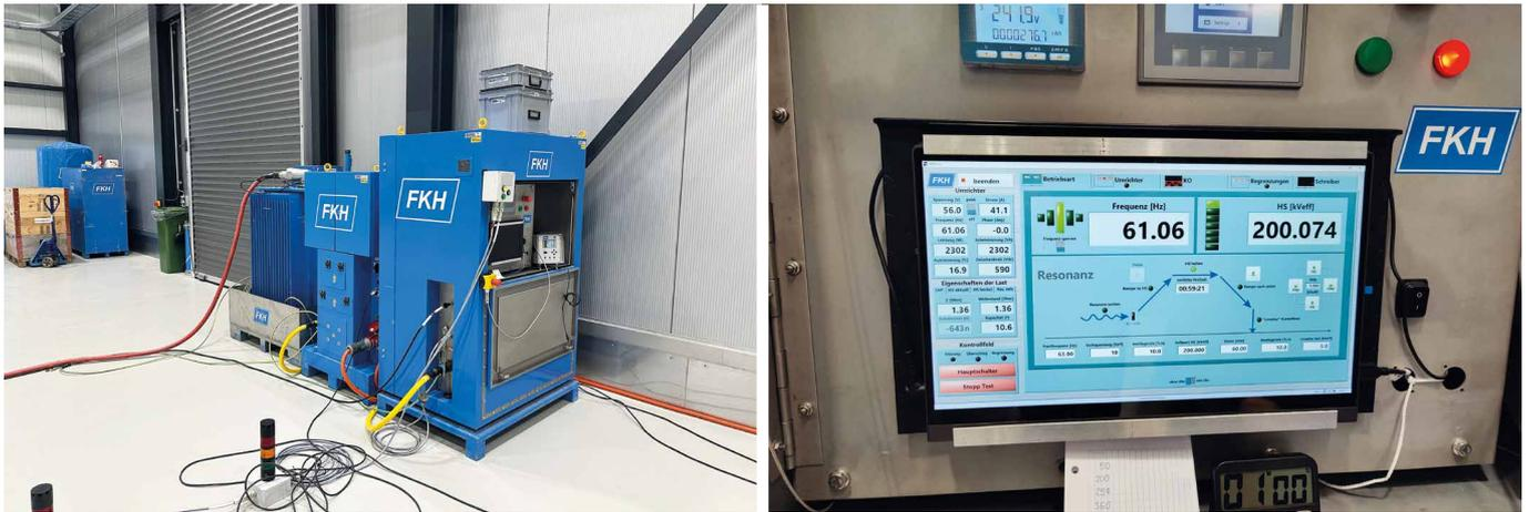
Abbildung 4: von links: Step-Up-Transformator, Trenntransformator und Frequenzrichter (links). Automatische Einstellung der Prüfspannung mit einem Rechner (rechts)
