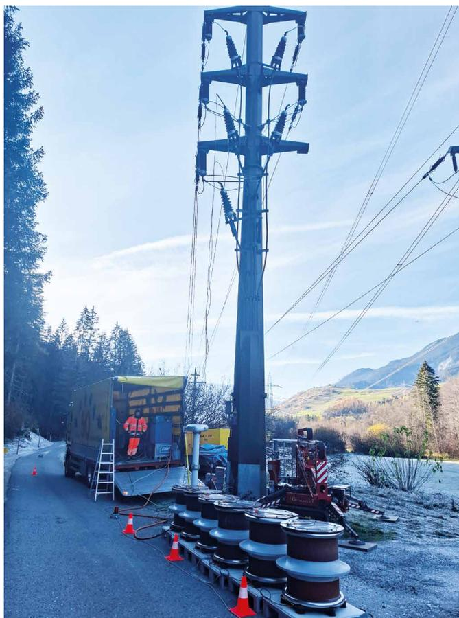
Abbildung 3: sechs 50-H-Drosseln parallel für eine 60-kV-Kabelprüfung
