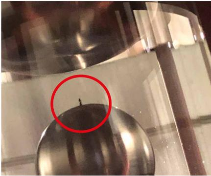
Abbildung 3: Versuchsaufbau Spitze-Platte-Anordnung mit isoliert herausgeführter Spitze auf Erdpotenzial
