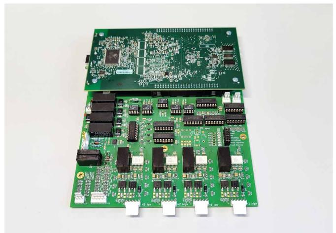
Abbildung 1: Leiterplatte der zweiphasigen Steuerung von Alff Engineering, rechts unten sind die vier Gate-Treiber zu sehen
