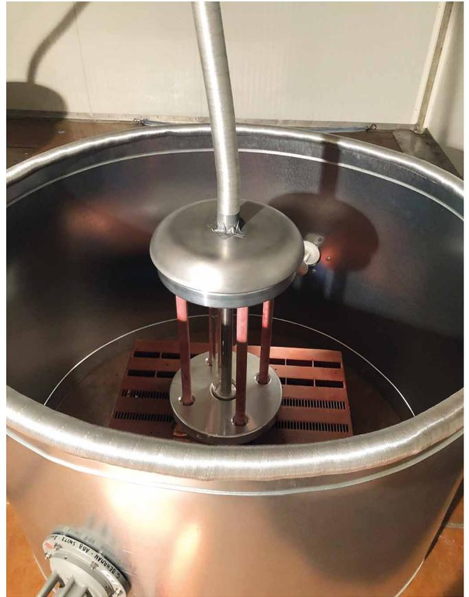
Abbildung 2: Versuchsaufbau zur systematischen Untersuchung des Teilentladungsverhaltens verschiedener Fehlstellen
