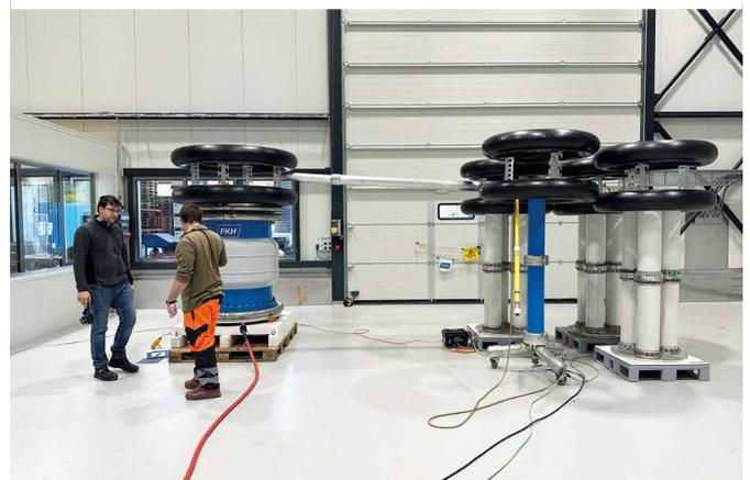
Abbildung 3: verschiedene Prüfanordnungen, bestehend aus 1 bis 3 HS-Drosseln in Serie, Spannungsteiler angepasst an Prüfspannung (blauer Turm) und Zusatzkondensatoren (weisse Türme), um die Resonanzfrequenz zu senken
