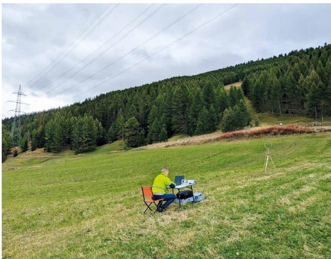
Abbildung 5: Überprüfung von berechneten Radiostörspannungen durch Freileitungskorona mit einem Störspannungs-Messempfänger
